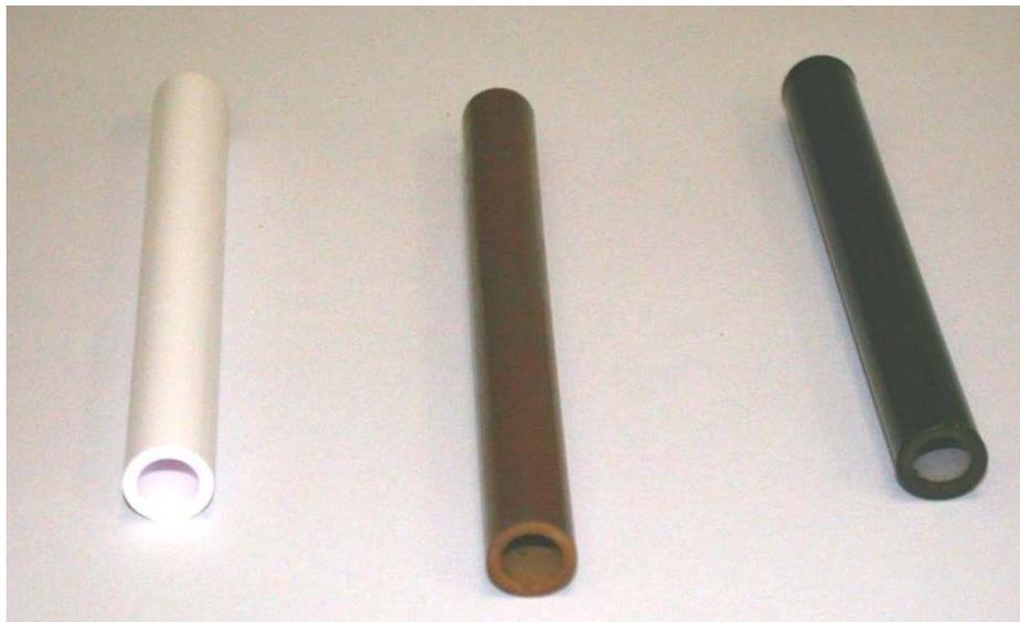
**Abb. 21.** Herstellung kohlenstoffbeschichteter keramischer Membranen. Links:  $\alpha$ -Al<sub>2</sub>O<sub>3</sub>-Membran im Ausgangszustand. Mitte: nach Beschichtung mit dem Furanharz und Trocknung. Rechts: Nach der Pyrolyse.
