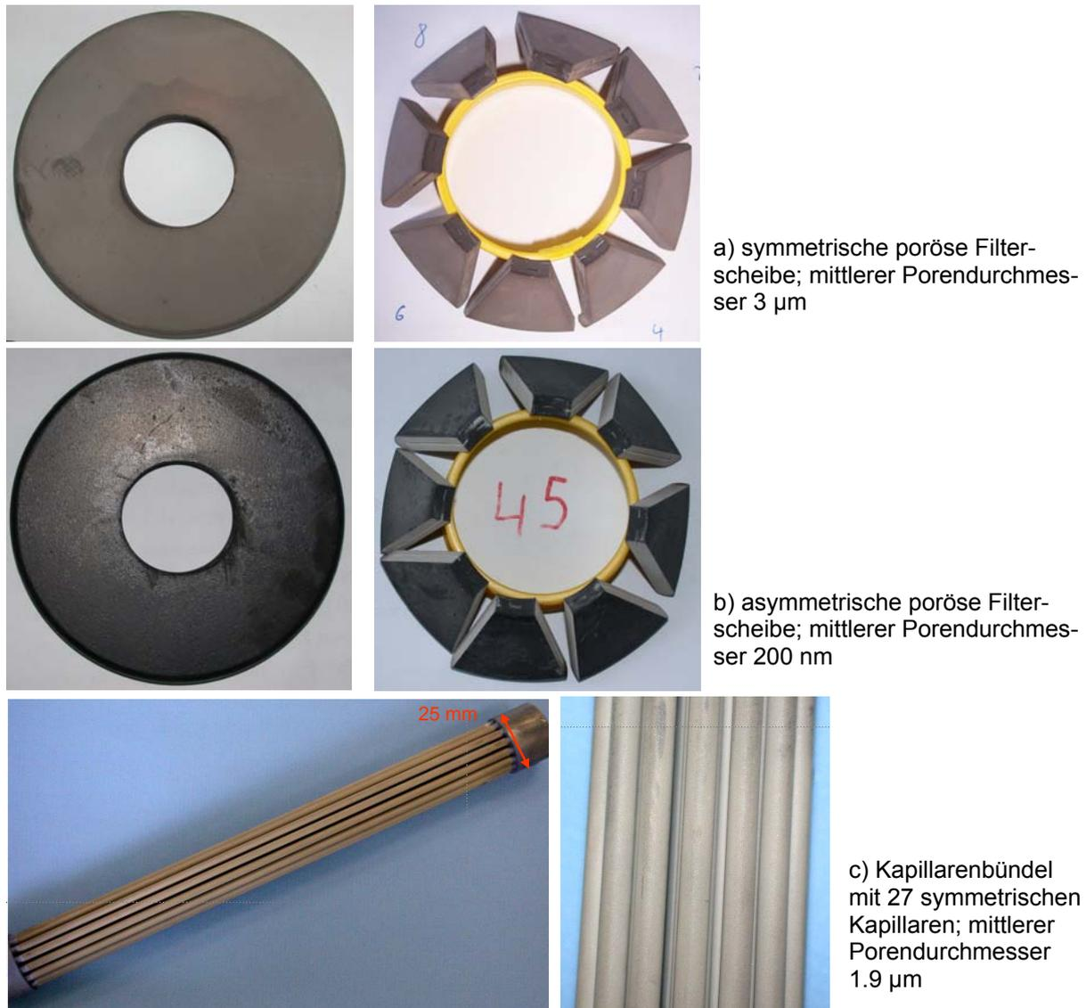
**Abb. 17.** Durch MOCVD mit Palladium beschichtete 90 mm Filterscheibe (a,b) und Kapillarenbündel (c) aus  $\alpha\text{-Al}_2\text{O}_3$ .
