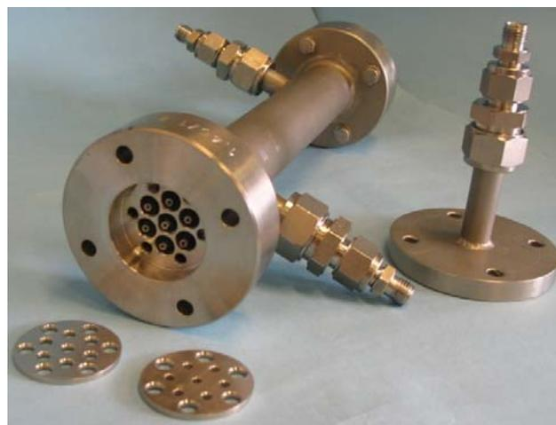
**Abb. 11.** Membranmodul für 7 Einzelkapillaren mit 2.9 mm Durchmesser und 250 mm Länge. Geometrische Membranfläche ca.  $165 \text{ cm}^2$  (am Außendurchmesser).
