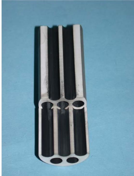
**Abb. 19.** 7-Kanal-Membranelement aus  $\alpha\text{-Al}_2\text{O}_3$ , auf der Innenseite der Kanäle beschichtet mit Palladium nach der Palladium-II-Acetat-Methode (mittlerer Porendurchmesser der feinporigen Deckschicht 100 nm).
