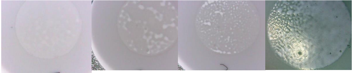
Abbildung 21: (V.l.n.r.) Fotografien der GDC 20 -Beschichtungsversuche mit dem Sieb S2 und GDC 20 -Pasten mit Feststoffanteilen von 30 (BP2), 40, 50 und 60 Gew.% nach Sintern.
