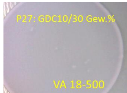
Abbildung 23: Fotografien der mit den beiden verdünnten GDC-Pasten P23 bzw. P27 gedruckten und bei 1280°C/3h gesinterten Sperrschichten.
