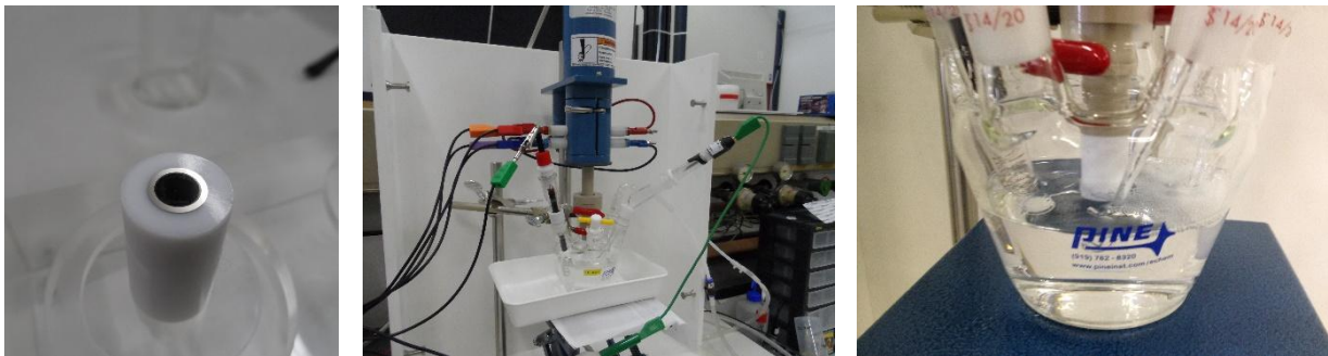
Abbildung 2: Fotografie (links) einer beschichteten Glaskohle-Elektrode, (mitte) des RRDE Aufbaus und (rechts) der Laborzelle.
