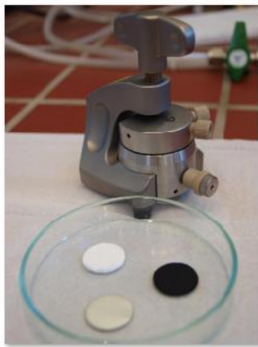
Abbildung 8: (Links) Fotografie der EL-Air Zelle mit GDE, Metallelektrode und Separator. (Rechts) Schematischer Aufbau der Zelle.
