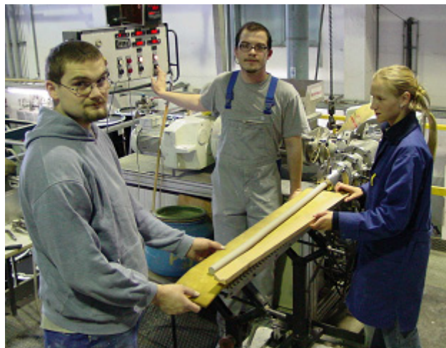
Abb. 3.2-19: Extrusion keramischer Träger in Mehrkanalgeometrie.
