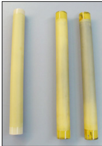
Abb. 3.2-39: Unbeschichtetes und mit Pd imprägnierte 19-Kanalrohre aus TiO 2 .
