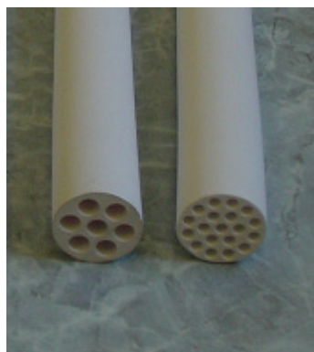
Abb. 3.2-20: Gesinterte keramische Trägerrohre in 7- und 19-Kanalgeometrie.
