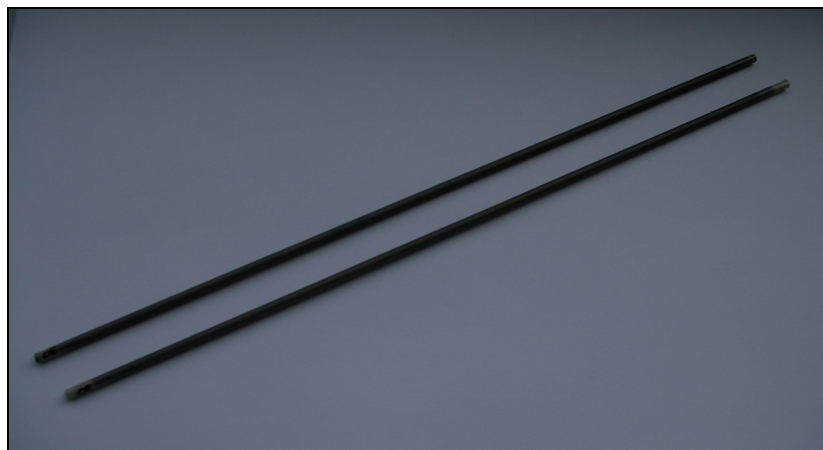
Abb. 3.2-22: Kohlenstoffinfiltrierte keramische Kapillaren.
