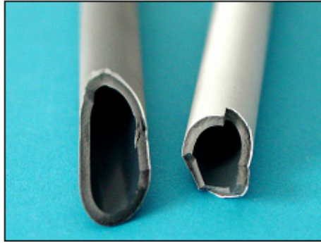
Abb. 3.2-13: Mit Polyester infiltrierte Membranprobe nach der Pyrolyse.
