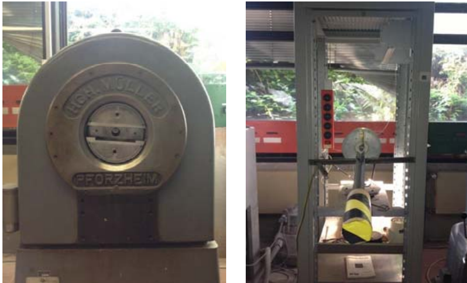
Abbildung 10: Rundknetanlage des Instituts für Werkstoffe (Bild links) und Röhrenofen mit Halterung für die Probenstangen (Bild rechts).
