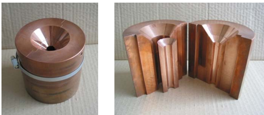
Abbildung 8: Gussform zusammengesetzt und verschraubt für das Einsetzen in den Ofen (Bild links). Mehrteilige Gussform mit dem zweiteiligen Einsatz für das Abgießen von Titanschmelzen (Bild rechts).
