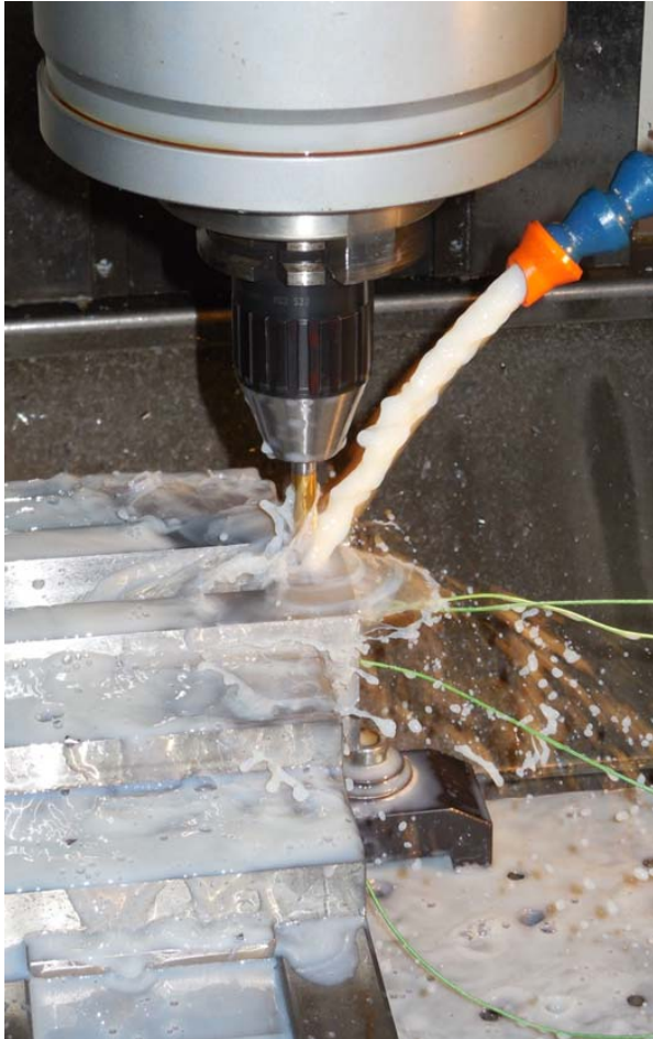
Abbildung 13: Durchführung der Bohrversuche mit KSS (Bild links). Abbildung des verwendeten Bohrers (Durchmesser 8 mm) mit TiN-Beschichtung (rechts oben) und der Beschreibung des Bohrers.
