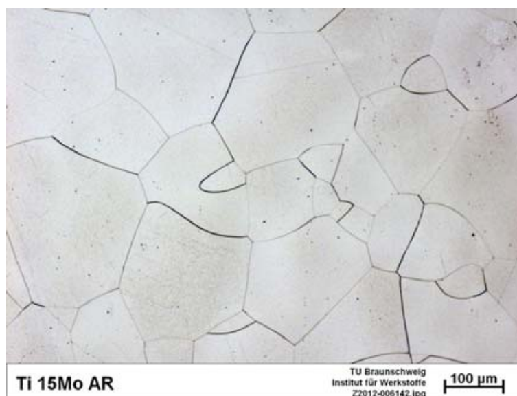
Abbildung 16: Lichtmikroskopische Aufnahme der Legierung Ti 15Mo im AR-Zustand von einer Randprobe. Grobkörniges \beta -Gefüge mit globularen Körnern. Die angeätzten Korngrenzen heben sich deutlich ab.
