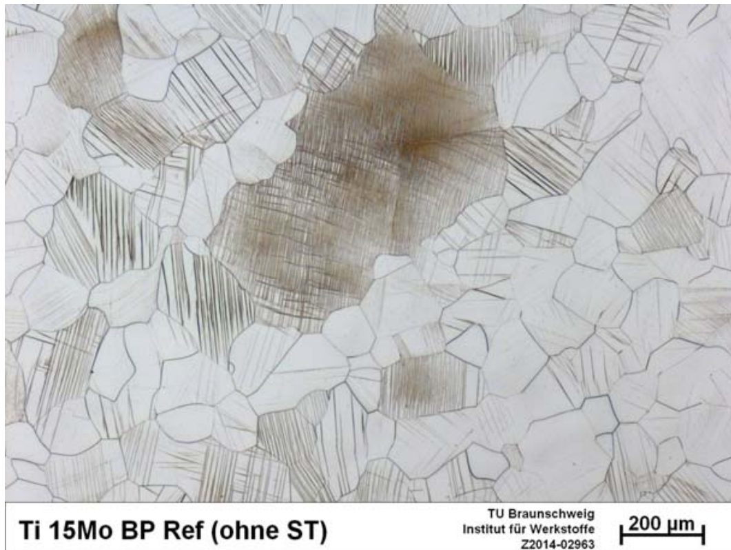
Abbildung 45: Lichtmikroskopische Aufnahme an der Bohrprobe BP Ref (ohne ST). Auf der gesamten Oberfläche sind Zwillinge sichtbar.
