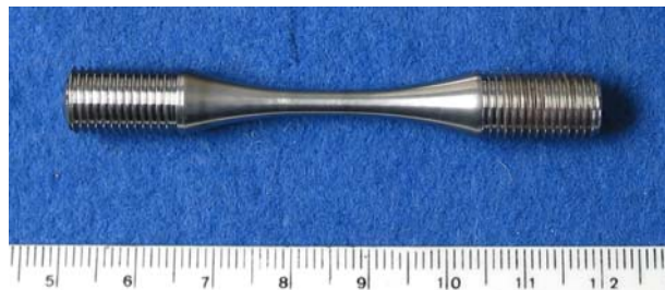
Abb. 24: Ermüdungsprobe mit kerbspannungsarmer Geometrie.
