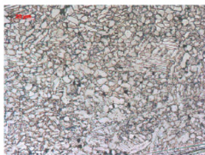
Abb. 10: Gefüge einer bei 900°C mit 0,1/s umgeformten Ti 6Al 4V 0,9La Legierung
