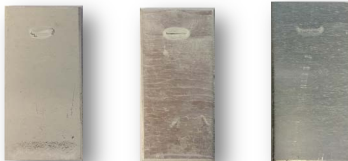
Abb. 3.2.5: Makroskopische Aufnahme der tauchbeschichteten Proben; links (pH 9.14, 20 Gew%, 15 mm/min), mitte (pH 9.72, 10 Gew%, 15 mm/min) und rechts (pH 9.01, 5 Gew%, 15 mm/min).
