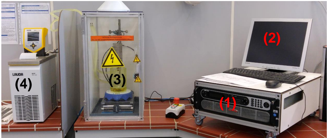
Abbildung 6: Aufbau und Equipment zur Herstellung der Beschichtungen mittels PEO: (1): Stromversorgung, (2): PC zur Messwertaufzeichnung, (3) Zelle, (4) Thermostat.
