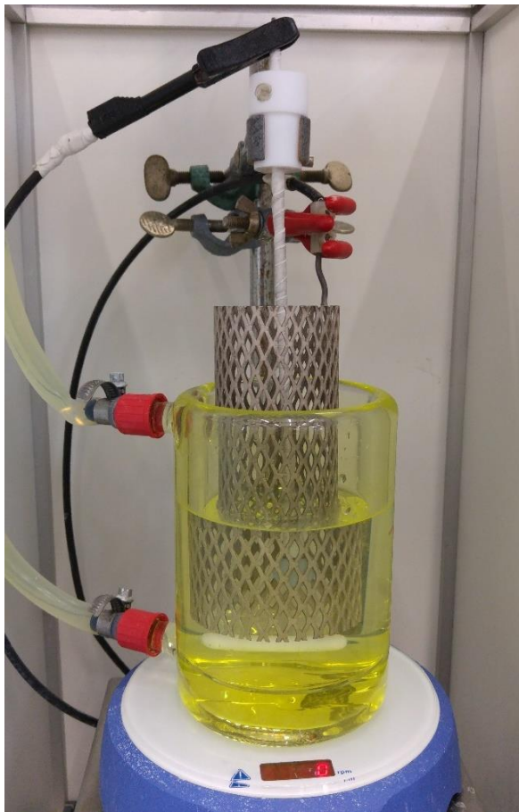
Abbildung 7: Aufnahme des a) Elektrodenaufbaus mit b) Detaildarstellung der Probe im Elektrolyt.
