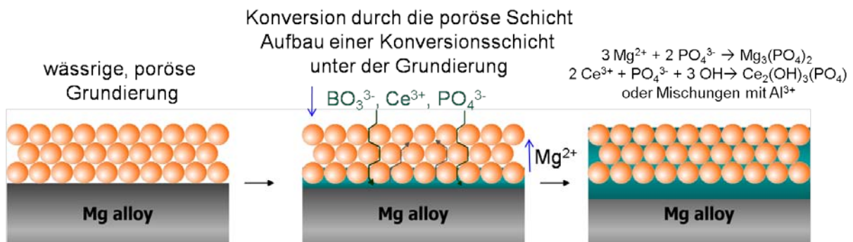
Abb. 52: Skizze für die Konversion von Magnesiumlegierungen durch eine poröse Nanopartikelschicht; Diffusion des Elektrolyten durch die Schicht zum Substrat bei gleichzeitiger Diffusion von Magnesiumionen in den Elektrolyt.
