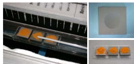
Probenform und Anordnung der Proben im Versuchsofen
