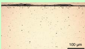
602CA (links) und 690 (rechts) nach 100h bei 800°C in Ar-0,2% Cl 2 -1%O 2 , Querschliff, im Diagramm mit '+' bezeichnet
