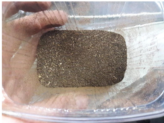
Abbildung 3.5: Torrefizierte Pellets nach Mahlung
