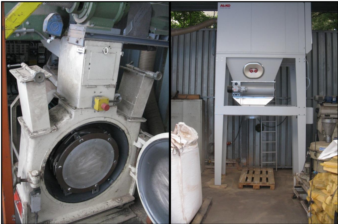
Abbildung 3.7: Biomasseaufbereitung (links: geöffnete Hammermühle, rechts: Staubabscheider)
