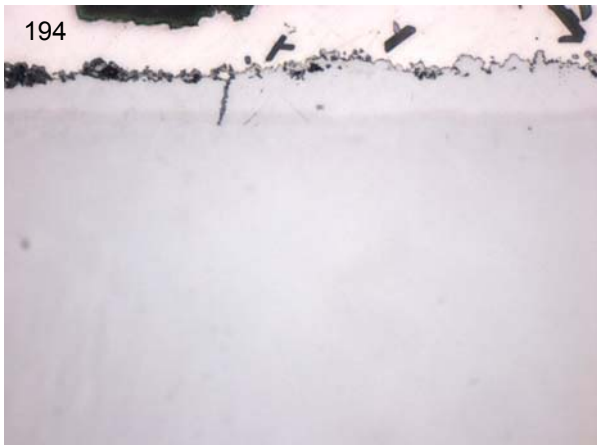
Abbildungen 194 + 195: Lichtmikroskopische (links) und rasterelektronenmikroskopische (rechts) Aufnahme des Querschliffs der alitierten Ti-Probe nach 25 Tagen thermozyklischer Oxidation bei 600°C in Laborluft
