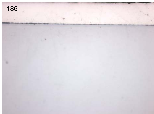
Abbildungen 186 + 187: Lichtmikroskopische (links) und rasterelektronenmikroskopische (rechts) Aufnahme des Querschliffs der unbehandelten Ti_3Al -Probe nach 25 Tagen thermozyklischer Oxidation bei 600^\circ C in Laborluft
