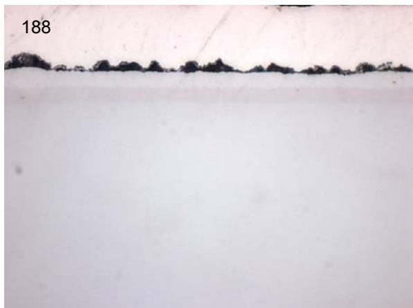
Abbildungen 188 + 189: Lichtmikroskopische (links) und rasterelektronenmikroskopische (rechts) Aufnahme des Querschliffs der alitierten Ti_3Al -Probe nach 25 Tagen thermozyklischer Oxidation bei 600^\circ C in Laborluft
