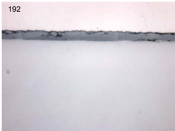
Abbildungen 192 + 193: Lichtmikroskopische (links) und rasterelektronenmikroskopische (rechts) Aufnahme des Querschliffs der unbehandelten Ti-Probe nach 25 Tagen thermozyklischer Oxidation bei 600°C in Laborluft
