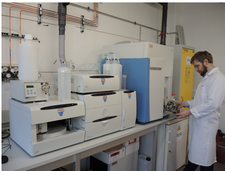
Der neue Ionenchromatograph mit angeschlossenem Plasma-gekoppeltem Massenspektrometer (Foto: DFI)
