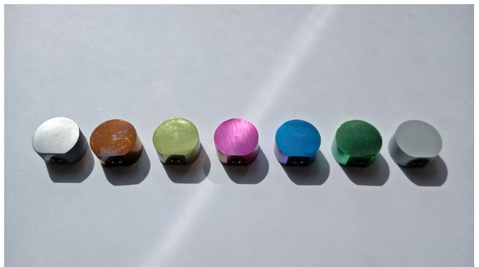
Anodisierte Titanproben: Die Oberflächen wirken je nach erzeugter Schichtdicke verschieden farbig. Dieser Prozess kann z.B. für das Farbcodieren von Titan-Bauteilen verwendet werden.
