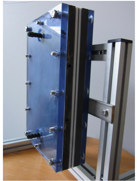
Das Bild zeigt eine Elektrosorptionszelle. Diese Zelle ist der Vorläufer der Zelle, die in ElektroWirbel entwickelt werden soll. (Foto: DFI).
