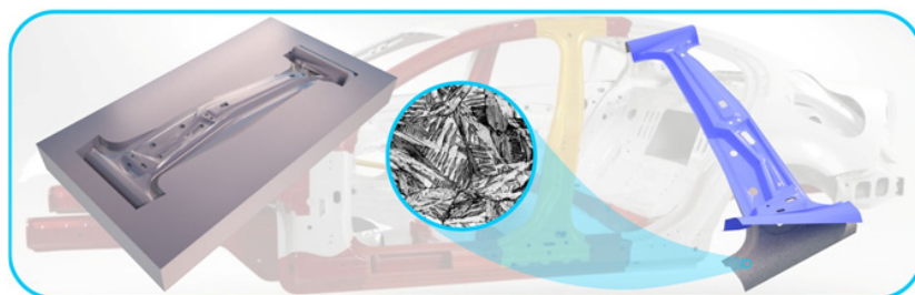
Hochfeste Stahlbauteile mit komplexer Geometrie werden durch den Presshärt-Prozess erstellt. Ein martensitisches Gefüge ohne Oxidationsprodukte wird durch eine passende Beschichtung gesichert. Pressgehärtete Stahlbauteile haben hohe Sicherheitsrelevanz für jedes moderne Auto.
