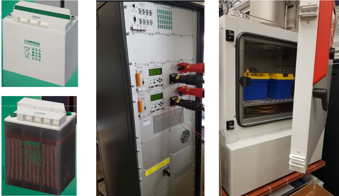
Abbildung 16: Links: Zwei 12 V-Module der Firma Hoppecke mit einer Kapazität von 50 Ah. Oben: VRLA Blei-Gel Batterie und unten: VL: Bleisäure-Batterie. Mitte: Großer 2-Kanal-Batterietester für Module der Fa. BaSyTec; Rechts: Temperierschrank für isotherme Tests der Batteriemodule der Fa. Binder.
