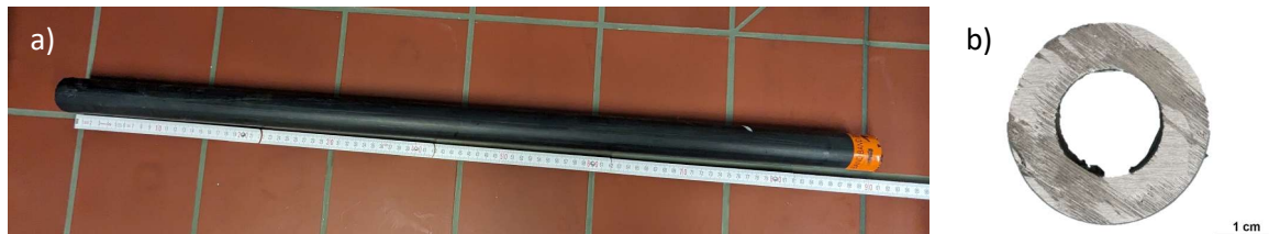
Abbildung 31: Ausgebautes Rohrsegment der Wasserstoffhochdruckleitung aus 1.4462 in Längsansicht (a) und im Querschnitt (b)
