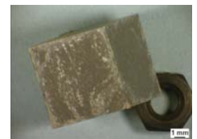
Abb.7: Gebildete Al 2 O 3 -Schicht auf der Oberfläche eines Würfels aus \gamma -TiAl.
