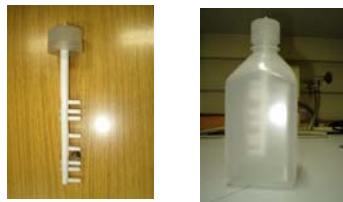
Abb. 1: Tauchvorrichtung für das Flüssigphasenverfahren
