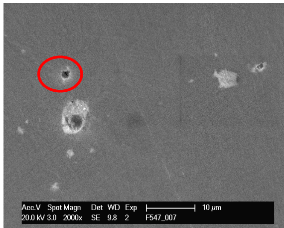
Abbildung 72: REM Aufnahme von Partikeln auf Ti-FM, Guss. Ein Partikel ist beinahe vollständig aufgelöst.
