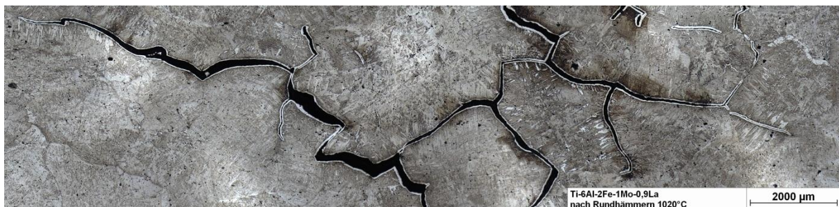
Abbildung 30: Längsschliff der Legierung Ti 6Al 2Fe 1Mo 0,9La nach dem Rundkneten.
