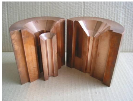
Abbildung 5: Gussform des Instituts für Werkstoffe. Die Außenform wird bei jedem Abguss verwendet während die Innenformen austauschbar sind. Es können verschiedene Stangengeometrien realisiert werden.
