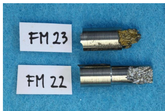
Abbildung 19: Proben der Legierung Ti-FM, die bei der Fertigung von Zugproben versagten.
