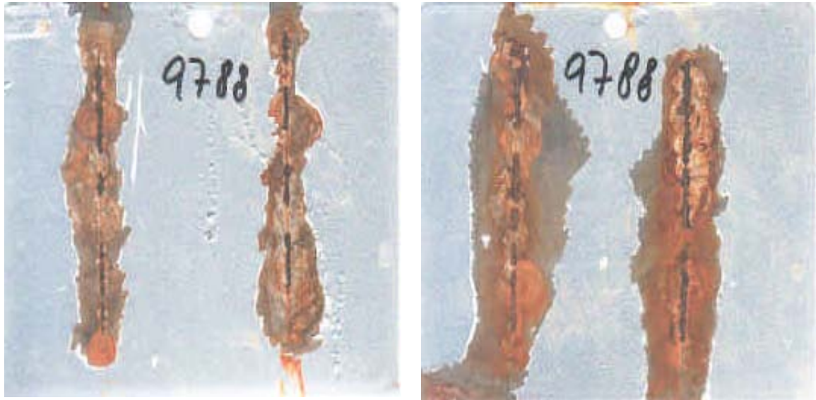
Abb. 18: Karosseriestahlbleche ( vgl. Abb. 14 ) mit Wischphosphatierung ( Surtec 608 ) als Vorbehandlung nach Korrosionswechseltest. Links ist ein Probeblech ohne SAM und rechts ein entsprechendes Blech mit DPS – SAM nach dem Test zu sehen.
