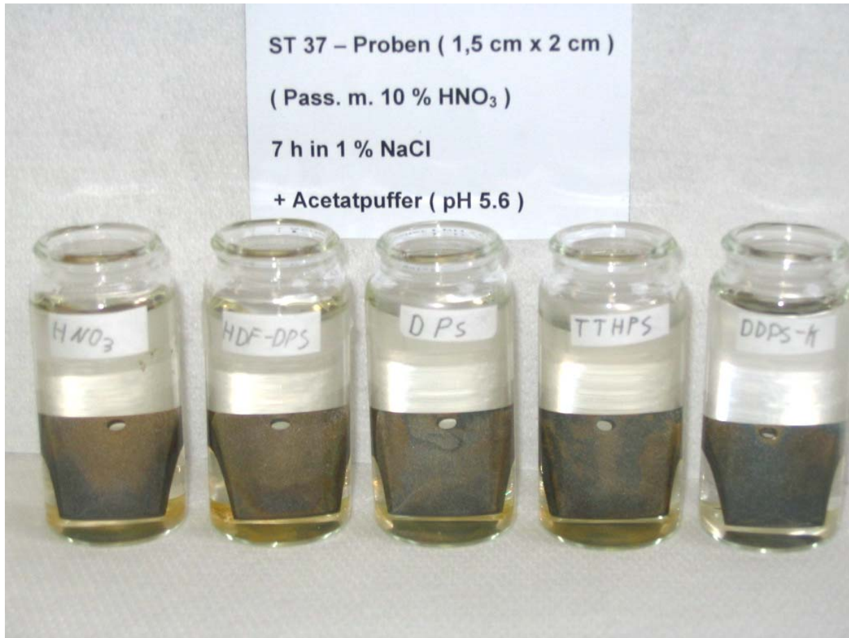
Abb. 16: St 37 Proben mit Passivierung in 10% HNO 3 . Das Bild wurde nach 7 h Tauchen in 1 % NaCl + Acetatpuffer ( 10 -3 M Essigsäure + 10 -2 M Na-Acetat ; pH 5.6 ) aufgenommen. V.l.n.r.: Ohne SAM, SAM mit HDF-DPS, DPS, TTHPS und DDPS. Gut erkennbar ist die deutlich reduzierte Korrosionsgeschwindigkeit bei der Probe mit DDPS – SAM ( rechts ).
