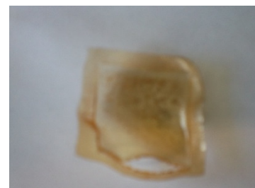
Abbildung 91: Von oben nach unten: Strukturformel der SPSU-PBI Säureüberschuss-Blend-Membran; Zusammensetzung der jeweiligen MEA, U-j-Verhalten in 2M MeOH/Luft bei 80°C & 2bar, Methanolpermeation in 1M MeOH/N 2 bei 80°C & 1,2bar; MEA3 nach DMFC-Test
