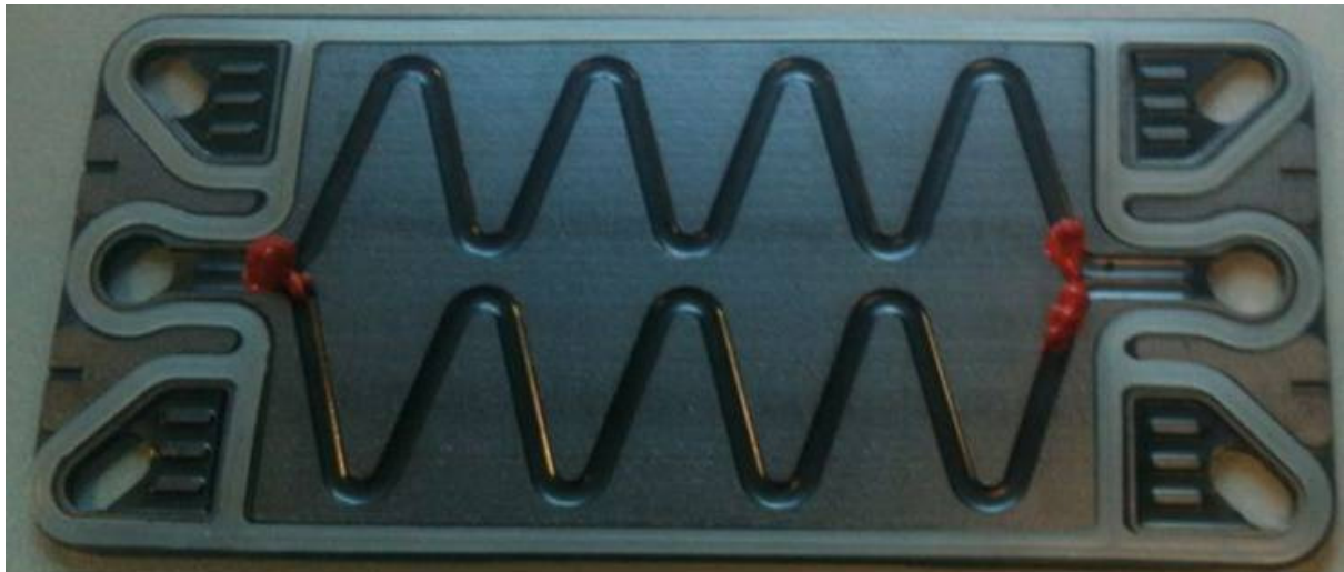
Abbildung 38: ZBT-Standard-Design, Wasserkühlseite mit Silikonabdichtungen
