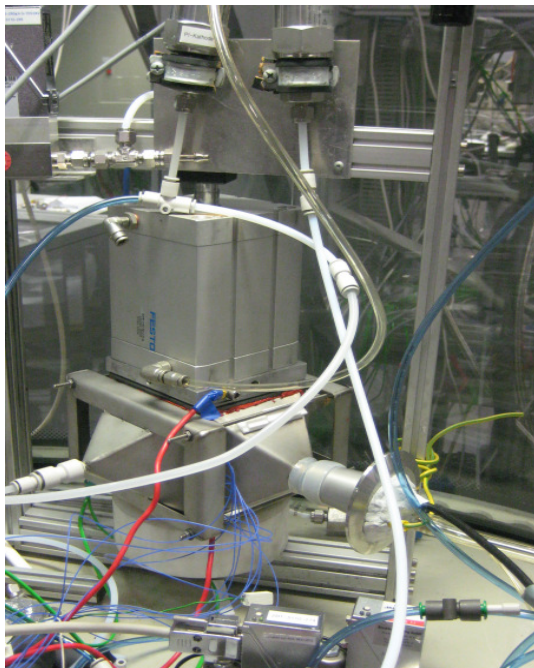
Abbildung 56: Links: MT-PEM Stack im Teststand des ZBT vor der Demontage Rechts: MT-PEM Stack mit demontierten Gasverteilern
