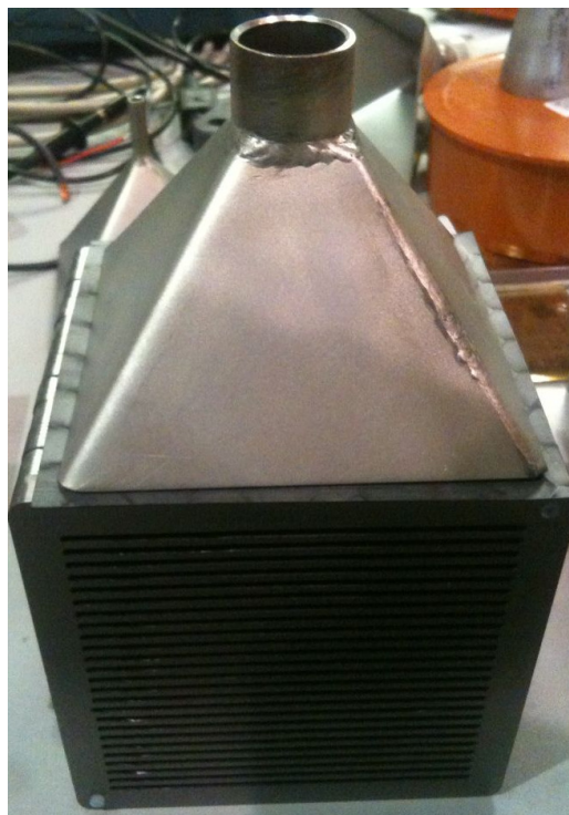
Abbildung 45: Seitenansicht mit aufgesetzter Gashutze
