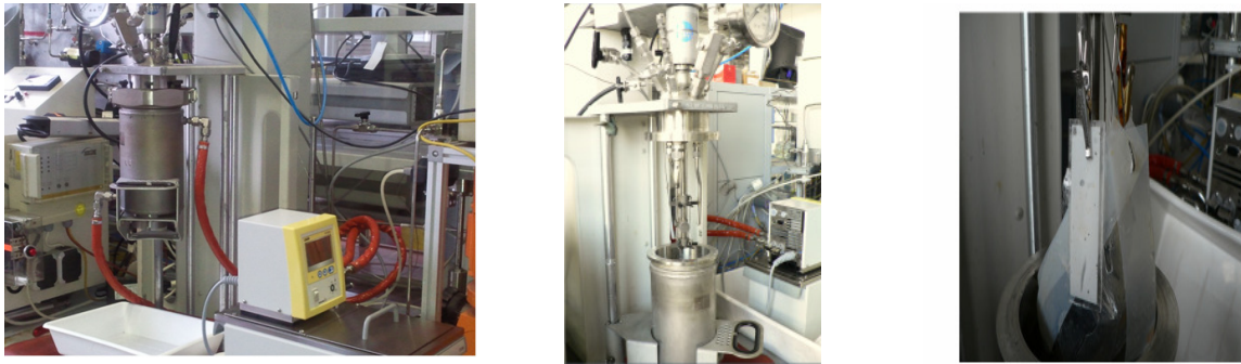
Abbildung 86: Reaktor zur Durchführung der Korrosionstests mit (rechts) Dichtungsmaterialien
