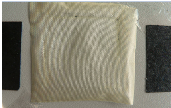
Abbildung 93: MEA24 mit sulfonierter bloc-copolymer Membran (IPF) nach dem Test in der 5 \text{ cm}^2 -DMFC
