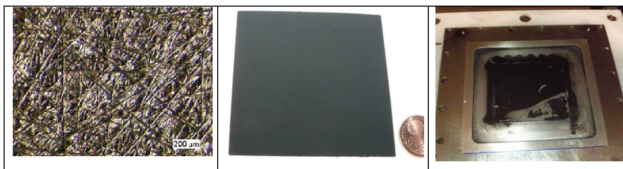
Abbildung 15: (Links) Lichtmikroskop-Aufnahme der Toray GDL (TGP-H-60), (Mitte) Bild einer mit Prism450 beschichteten 55x55 mm GDE ( 3 \text{ mg}_{\text{Pt}}/\text{cm}^2 PtV/CX190) und (rechts) Beispiel für einen misslungenen Sprühvorgang bei dem eine Selbstentzündung der Pt/C-Reaktionssicht stattfand.
