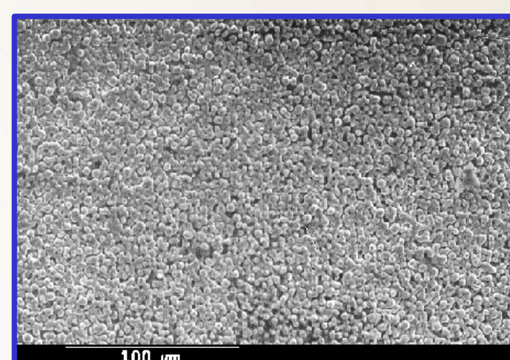
asymmetrischer Sintermetallträger aus Edelstahl (Oberfläche); 2 Schichten; d p ca. 1 µm
