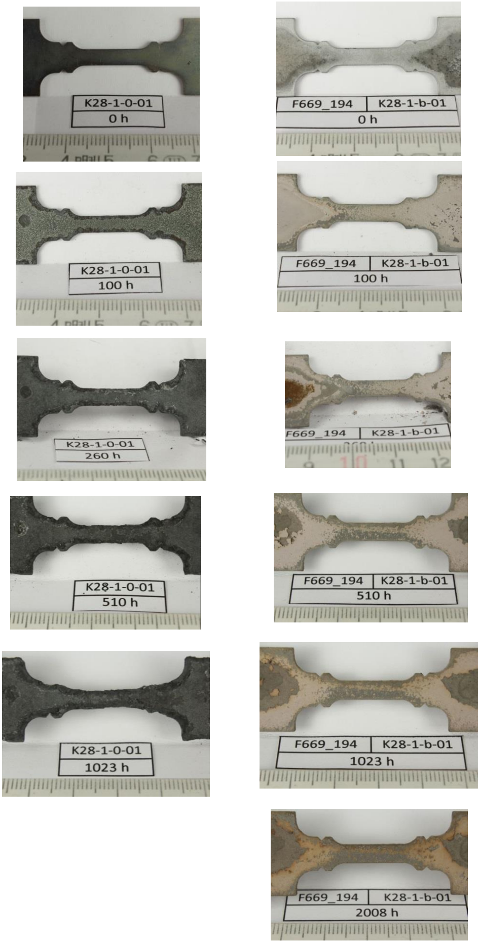
Bild 139: Fotos der Prüflänge der Flachzugproben aus dem 1 mm Blech des Werkstoffes 1.4828 im unterbrochenen Kriechversuch bei 1000 °C unter vergleichbarer Last
