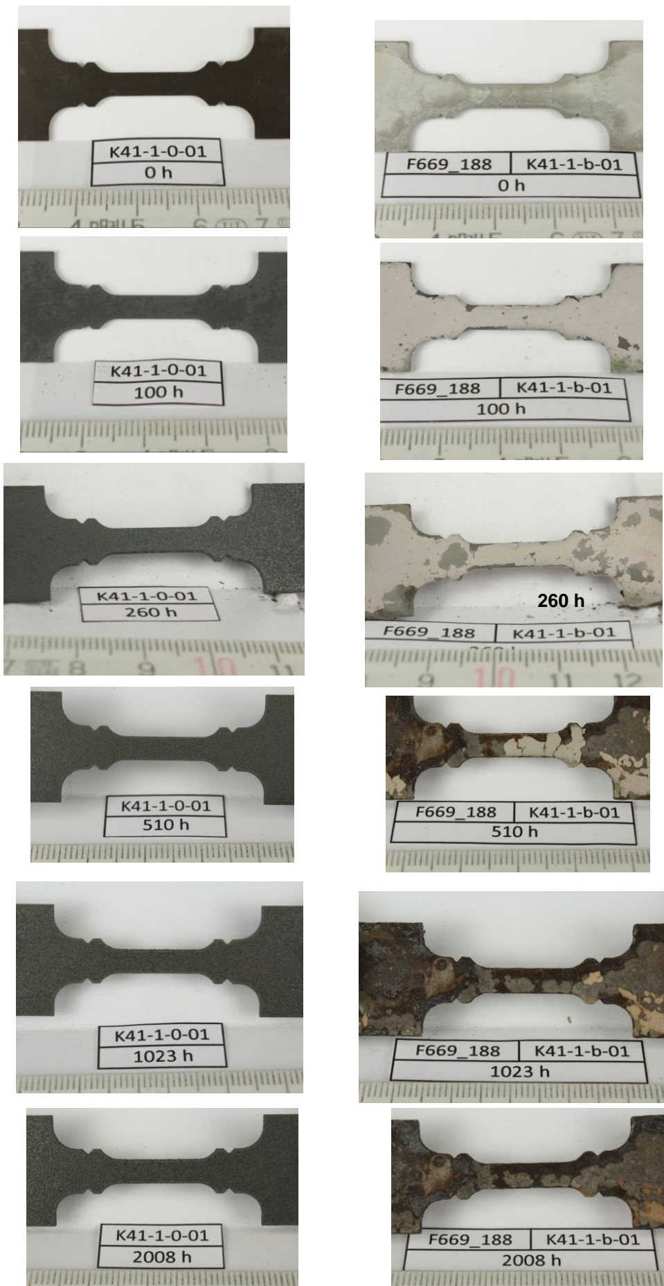
Bild 141: Fotos der Prüflänge der Flachzugproben aus dem 1 mm Blech des Werkstoffes 1.4841 im unterbrochenen Kriechversuch bei 1000 °C unter vergleichbarer Last
