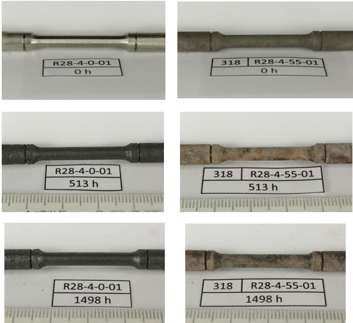
Bild 149: Fotos der Prüflänge der Rundzugproben des Werkstoffes 1.4828 im unterbrochenen Kriechversuch bei 1000 °C unter vergleichbarer Last; links: nicht beschichtete Proben, Last 2,39 MPa ; rechts: beschichtete Proben, Last 2,16 MPa
