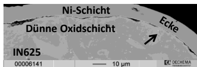
Abbildung 9: Lichtmikroskopische Aufnahme der einer rechteckigen Probe aus IN 625 ausgelagert für 168 h bei 450°C. Aufnahme im Querschliff. Vor dem Versuch betrug der mit Pfeil markierter Winkel 90°.
