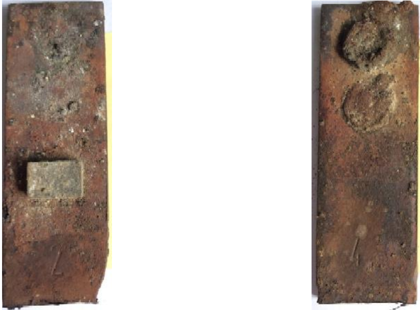
Abbildung 32: Haltebleche nach Ausbau aus der Versuchsanlage nach ca. 4,5 Monaten. Links der Halter aus Abbildung 31 , bei dem nur die Referenz den Versuch überdauert hat. Rechts Reste der Proben am Halter 4, der ohne Referenz eingesetzt worden war.
