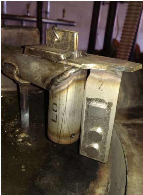
Abbildung 31: Einbausituation für gespritzte Proben im Vergasungsreaktor PowerGen der Fa. Qualovis. Oben die Referenz Alloy 625, darunter die Fe-Basis, ganz unten die FeNi-Basislegierung.
