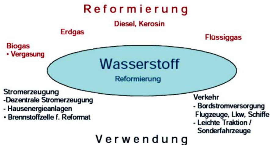
Abbildung 2: Verwendung von kohlenstoffhaltigen Energieträgern anhand direkter Reformierung für die dezentrale Versorgung mit Wasserstoff.(7)
