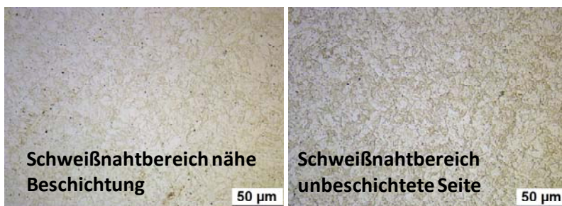
Bild 6.24: Gefügeaufnahmen des Schweißnahtbereichs nach der Beschichtung
