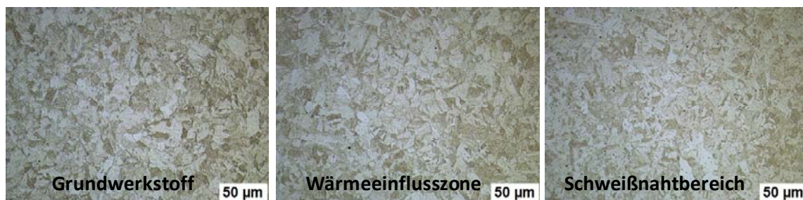
Bild 6.22: Gefügeaufnahmen im Bereich der Schweißnaht und des Grundwerkstoffs
