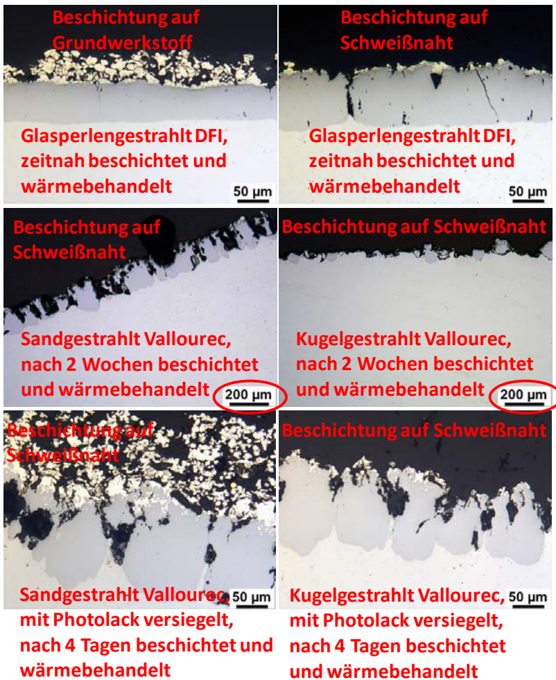
Bild 6.23: Querschliffaufnahmen induktiv behandelter, geschweißter P91-Rohrbogenstücke mit unterschiedlicher Vorbehandlung
