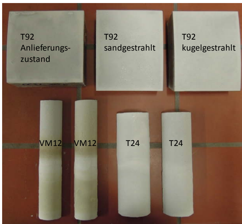
Bild 5.5: Bauteilproben diverser Werkstoffe nach dem Besprühen mit Al-Standardpulver
