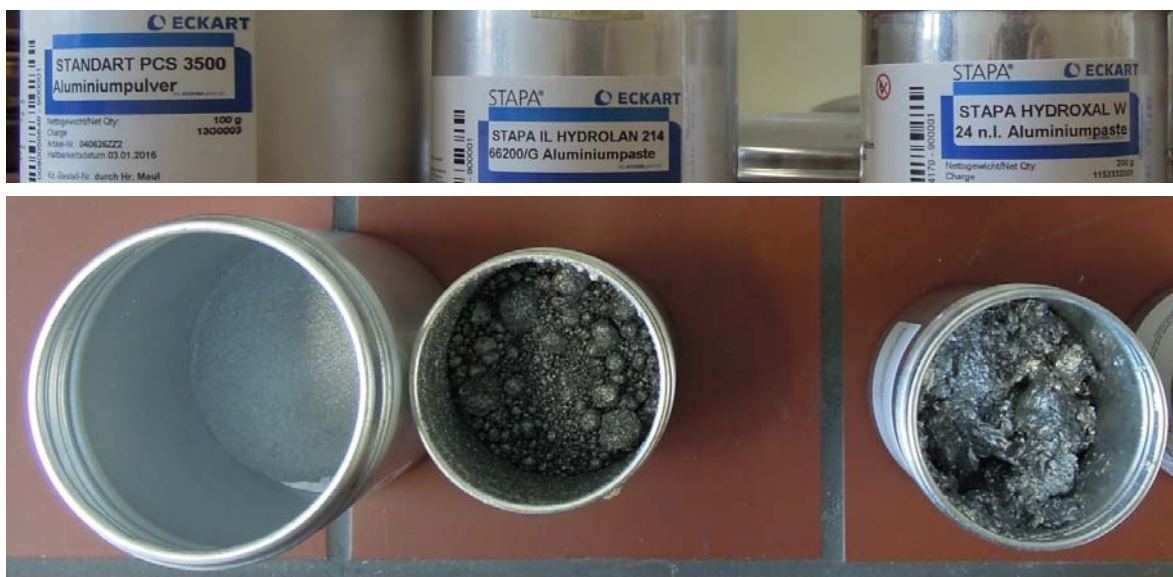
Bild 5.3: SiO 2 -gekapselte Pulvervarianten der Firma Eckart im Anlieferungszustand
