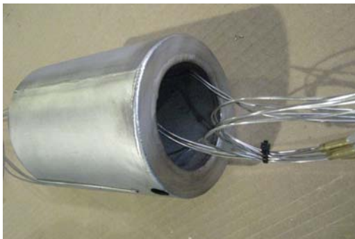
Abbildung 4: Reformerreaktor mit aufgeschweißten Thermoelementen
