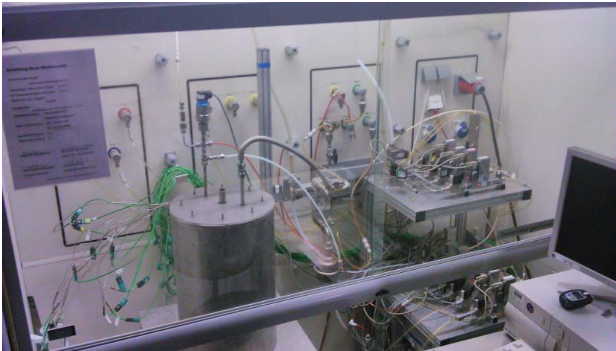
Abbildung 48: Reformersystem in Isolationshülle und Teststandsumgebung
