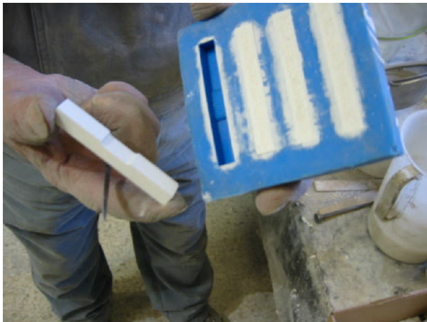
Abbildung 5: Entnahme der fertigen Grünlinge aus den Silikonnegativformen: 4-Punkt Biegeproben (links) und Rechteckplatte (rechts).
