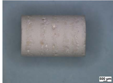
Abbildung 7: Aus den Rechteckplatten ausgebohrte Zylinderproben ( \varnothing=5\text{mm} ) für die Dilatometrie.
