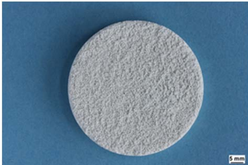
Abbildung 6: Aus den Rechteckplatten ausgebohrte Kreisproben ( \varnothing=50\text{mm} ) für die Porosimetrie. Das obere Bild zeigt die glatte Oberseite und das untere Bild die raue Unterseite.
