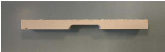
Abbildung 8: Mittels Schichtenkeramik-Verfahren aufgebaute 4-Punkt Biegeprobe
