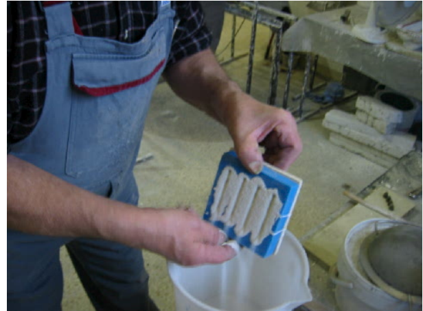
Abbildung 4: Herr Grundhöfer bei der Anfertigung von 4-Punkt Biegeproben in der Silikonform.
