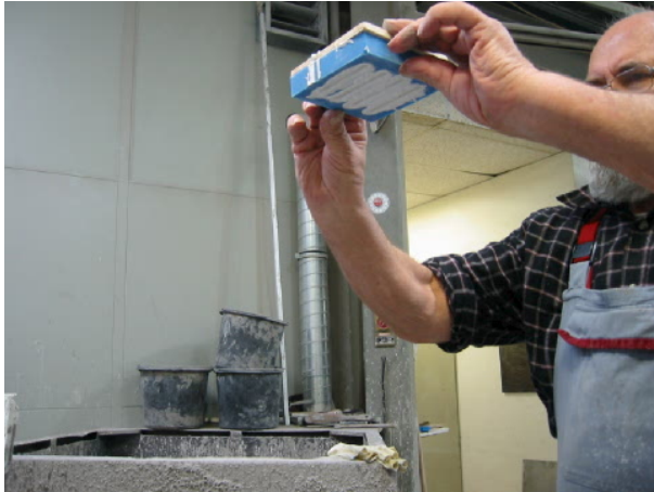
Abbildung 4: Herr Grundhöfer bei der Anfertigung von 4-Punkt Biegeproben in der Silikonform.
