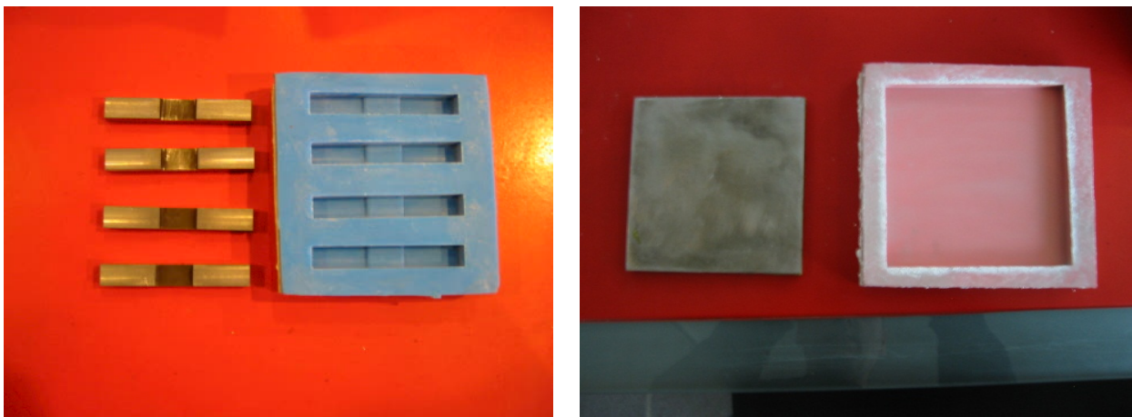
Abbildung 3: Stahlmodelle und angefertigte Silikonnegativform für die 4-Punkt Biegeproben (links) und die Rechteckplatten (rechts).
