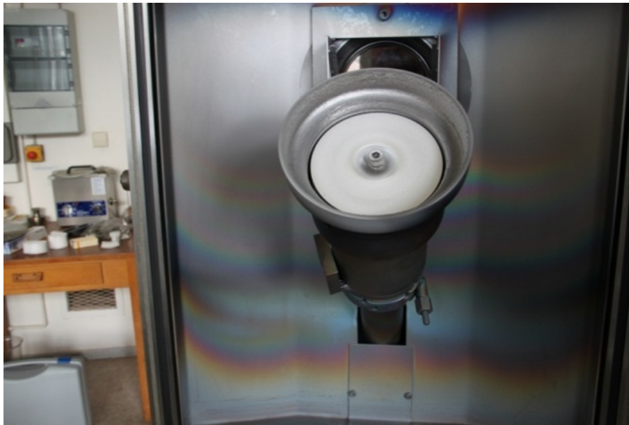
Abbildung 15: PVD-Abscheidung aus einem senkrecht aufgestellten Target
