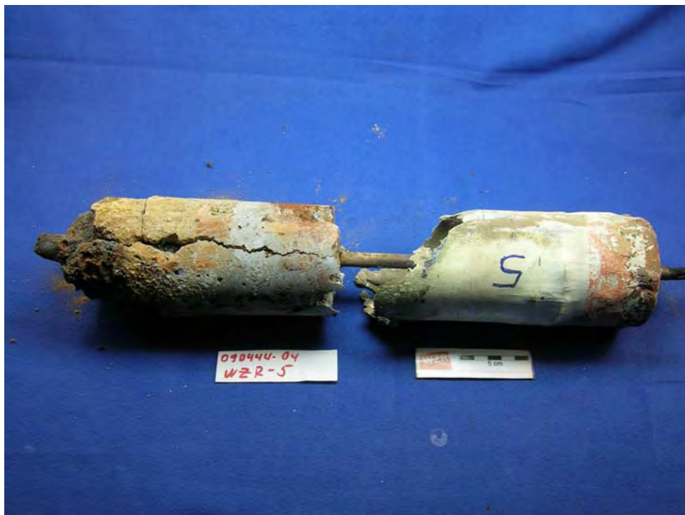
Abbildung 36: Fotografische Dokumentation der Probe WZR5 nach dem Einsatz in der MVA.
