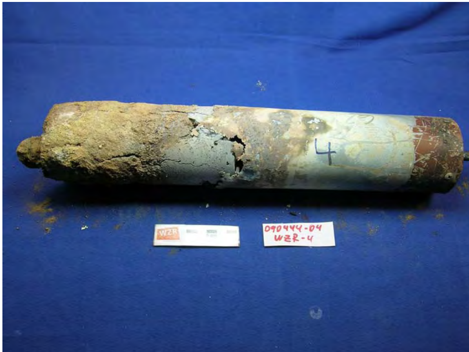
Abbildung 25: Fotografische Dokumentation der Probe WZR4 nach dem Einsatz in der MVA.
