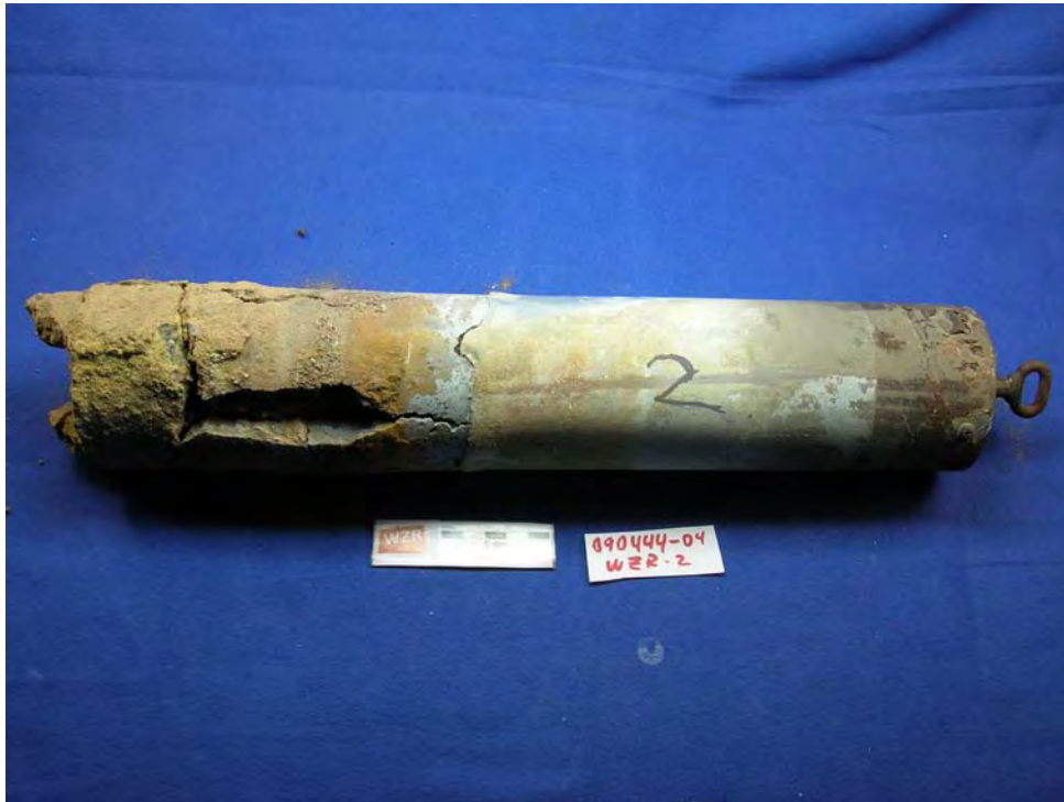
Abbildung 16: Fotografische Dokumentation der Probe WZR2 nach dem Einsatz in der MVA.
