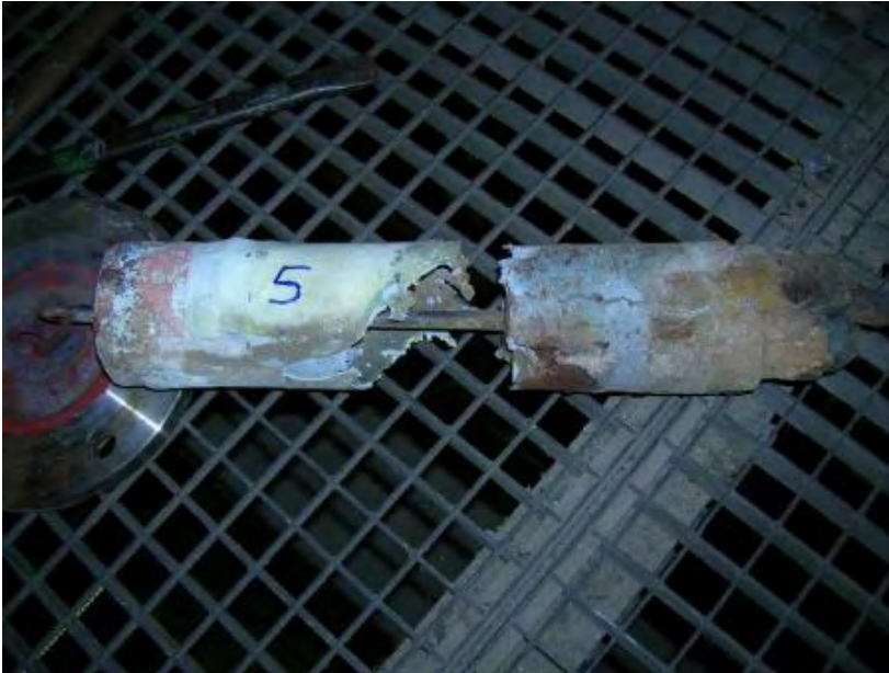
Bild 7.59: Ausbau der Anker der MVA Bonn; Teile des Versuchsaufbaus sind nicht mehr vorhanden
