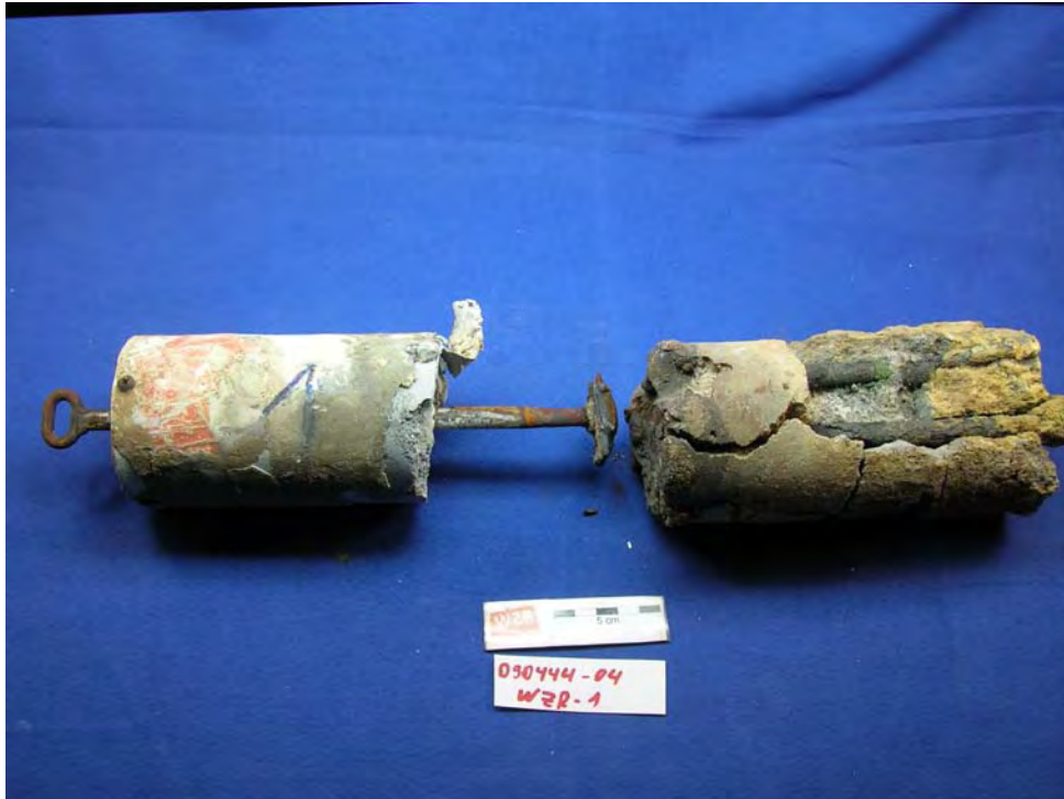
Abbildung 1: Fotografische Dokumentation der Probe WZR1 nach dem Einsatz in der MVA.
