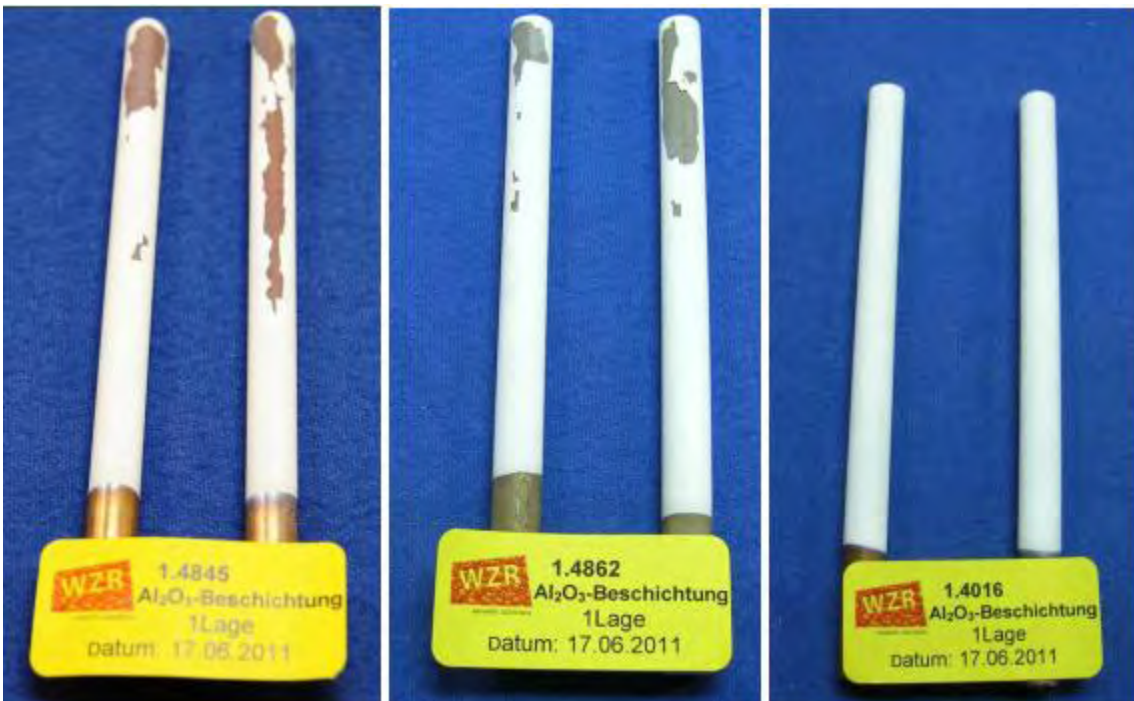
Bild 7.54: Mit \text{Al}_2\text{O}_3 im Sol-Gel-Verfahren beschichtete Ankerwerkstoffe; die austenitischen Werkstoffe zeigen Abplatzungen, der ferritische (rechts) nicht
