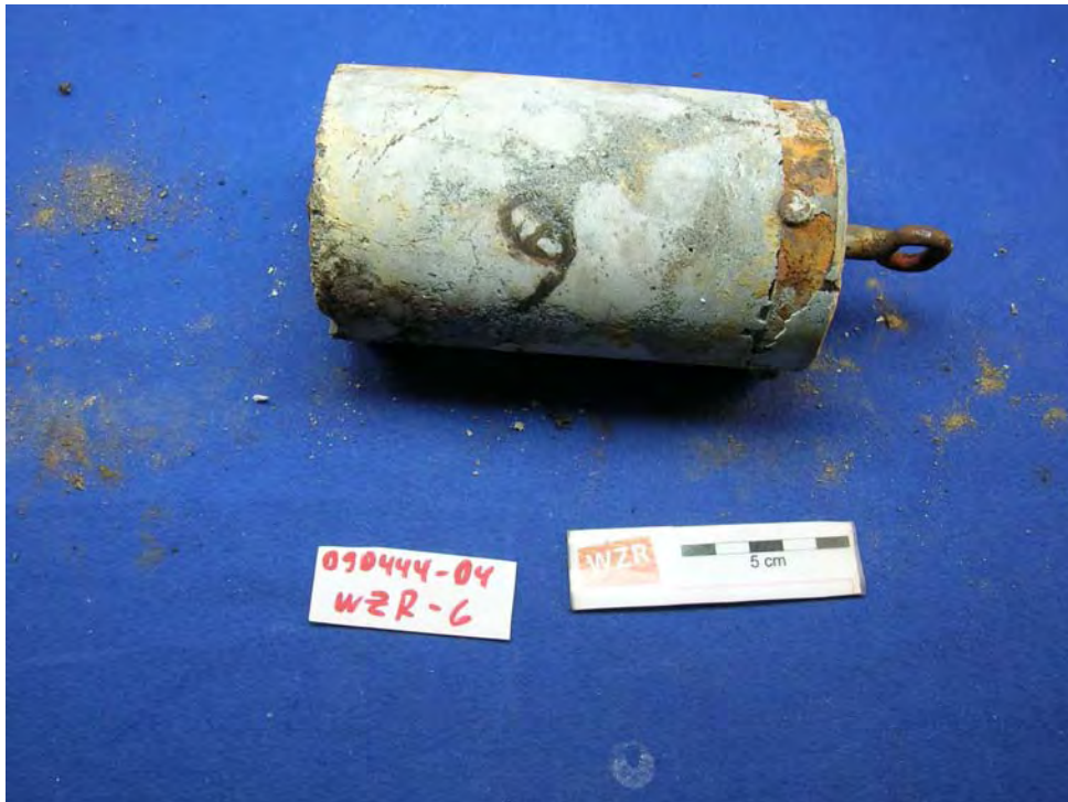
Abbildung 48: Fotografische Dokumentation der Probe WZR6 nach dem Einsatz in der MVA.
