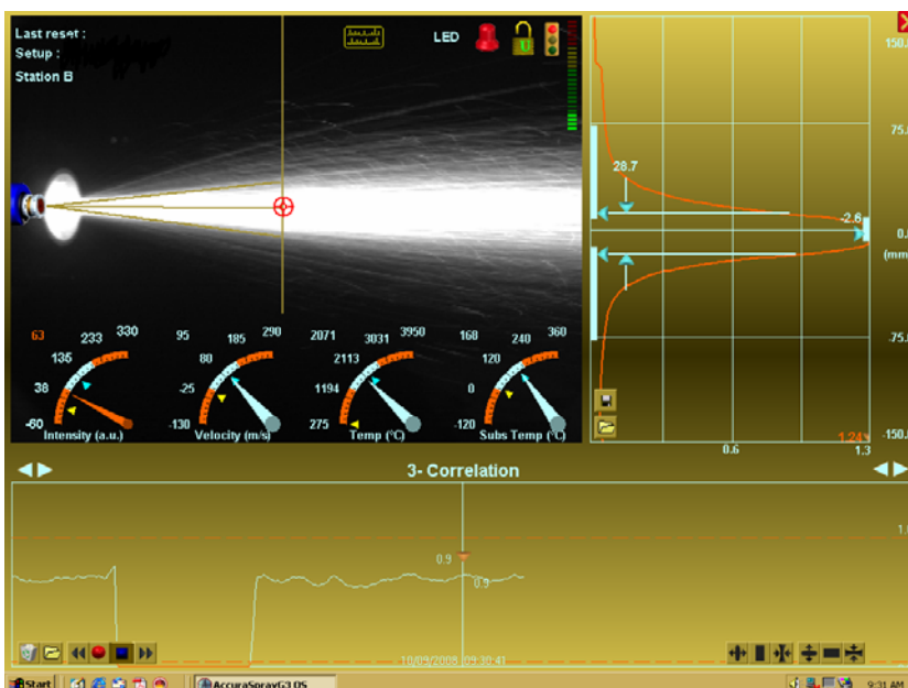
Bild 10: Prozessanalyse Lichtbogenspritzen der Legierung B mit VisuArc
