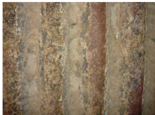
Bild 42: Feldversuch; links nach dem Beschichten, rechts nach mehrwöchigem Betrieb
