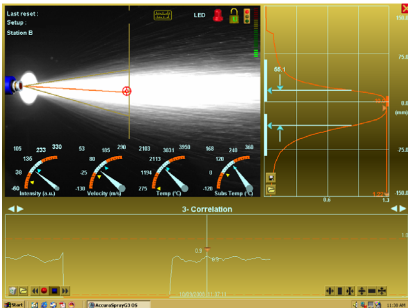
Bild 13: Prozessanalyse Lichtbogenspritzten der Legierung C mit VisuArc
