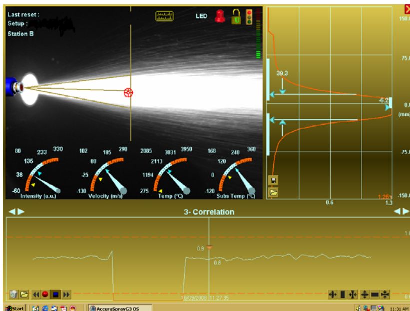
Bild 11: Prozessanalyse Lichtbogenspritzen der Legierung B mit VisuArc
