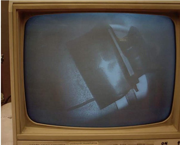
Abbildung 43: Kontrolle der Messstelle mittels eingeschwenkten Laserstrahls
