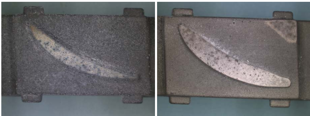
Abbildungen 78 + 79 Aufnahmen der alitierten Turbinenschaufelfüße direkt nach Pack (links) und nach Oxidation (rechts)
