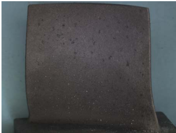
Abbildung 84: Fotografische Aufnahme einer in Gänze alitierten Verdichterschaufel für eine Flugzeugturbine
