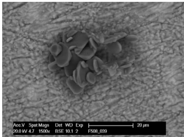
Abbildungen 27 + 28: REM-Aufnahme und EDX-Spektrum der Oberfläche einer Ti-Probe nach in pack Prozess (0.1% \text{NH}_4\text{Cl} +1%Al)
