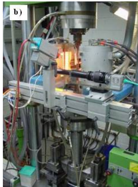
Bild 5.8 Darstellung der Anordnung der Strahler im Ofen (a) in der Draufsicht und (b) Foto der TGMF-Prüfeinrichtung
