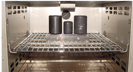
f) In den Ofen stellen; Gewichte auflegen; Schrauben lösen; Wärmebehandlung
