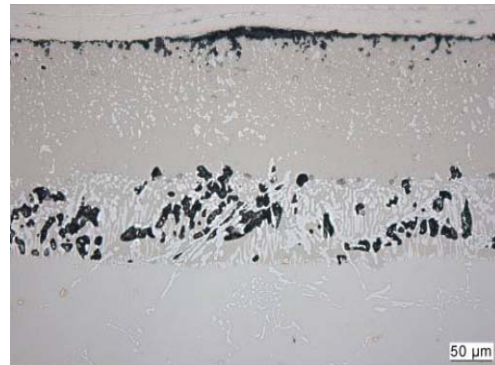
Abb. 18: Leg. 49M30 mit Aluminium-Diffusionsschicht nach 300h Auslagerung in 5% Cl 2 + synth. Luft bei 1000°C
