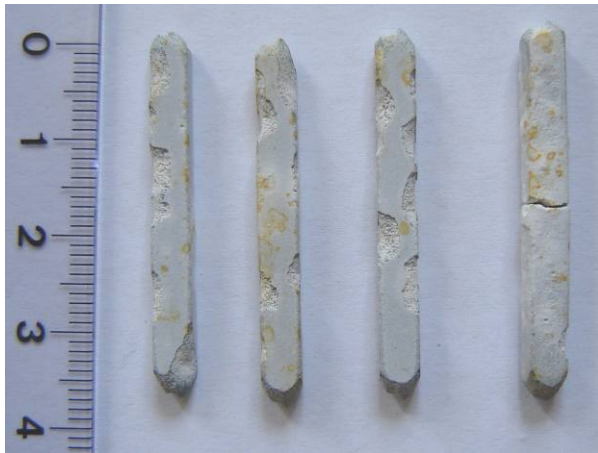
Abb. 29: NSiC-Proben nach 168-stündiger Behandlung zusammen mit \text{Fe}_2\text{O}_3 -reicher Klärschlammasche und einer Atmosphäre aus Luft und 10% \text{Cl}_2 im Pendelrohrföfen bei 1000^\circ\text{C} . Die Probenstäbchen haben ca. 20% ihrer ursprünglichen Länge eingebüßt (vgl. Originalstäbchen in Abb. 28) und zeigen schwere bis schwerste Korrosionsschäden, die jedoch lokal begrenzt sind. Sie treten überall dort auf, wo die äußere \text{SiO}_2 -Schutzschicht durch den abrasiven Angriff beschädigt ist und das \text{Cl}_2 das Si-reiche Substrat angreifen kann. Die um ein Vielfaches stärkere
