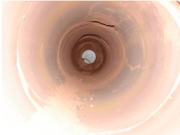
Abb. 34: Blick in den rohrförmigen Korundreaktor des kleintechnischen Drehrohrofens nach der Klärschlammmaschenbehandlung bei 1000°C. Das Rohr zeigt Querbrüche in den Übergangszonen von der heißen Rohrmitte zu den kühleren Rohröffnungen an den Enden sowie eine Reihe von Längsrissen. Die Beschädigungen sind jedoch keine Folge einer chemischen Korrosion, sondern gehen vielmehr auf die schlechte Temperaturwechselbeständigkeit und die damit verbundene Bruchanfälligkeit des Korunds zurück.
