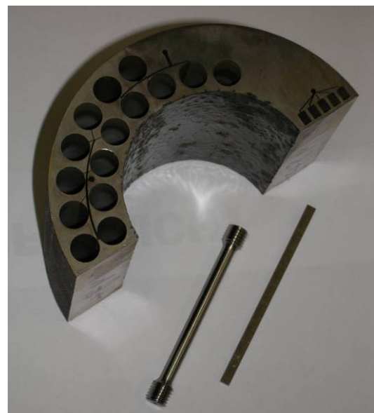
Abb. 7: Links: schematische Darstellung der Probenentnahme aus der Rohrgeometrie. Die geprüften Proben sind farblich gekennzeichnet. Rechts: Metallischer Grundwerkstoff mit jeweils einer daraus präparierten Zug- und E-Modulprobe (Biegeprobe).
