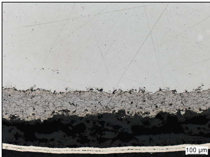
Abbildung 36: Querschliff der APS Beschichtung P1 in Ar-1 %Cl 2 - 1 % O 2 nach 100 h bei 800°C
