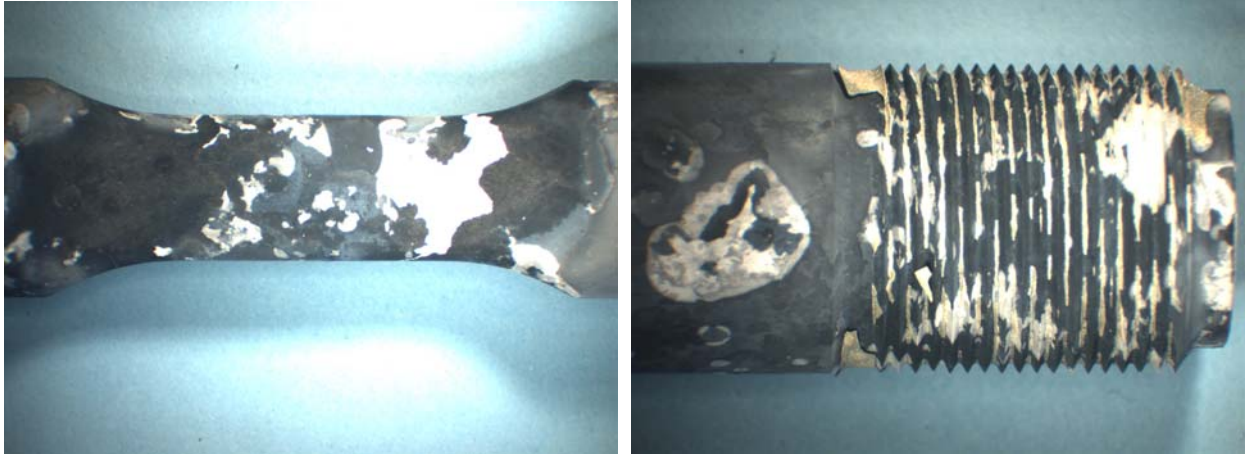
Abbildungen 37 + 38: Stereolupenaufnahmen der nicht implantierten Zugprobe nach 100h bei 1050°C in Laborluft
