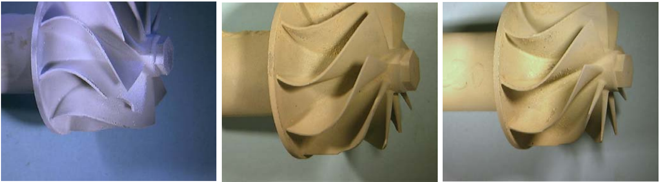
Abbildungen 62 – 64: Stereolupenaufnahmen des F-behandelten Rotors vor Oxidation (links), nach 600 h (mittig) und nach 1200 h (rechts) Oxidation bei 1050°C in Laborluft
