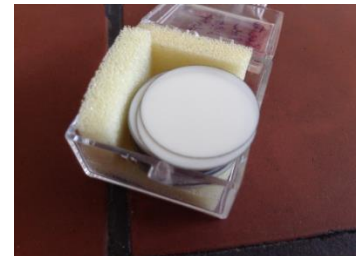
Abbildung 12: (A) Siebdruckmaschine EKRA1, (B) Vakuuttisch zur Befestigung und Positionierung der keramischen Elektrolyten und (C) 3YSZ-Elektrolyte der Fa. CeramTec.
