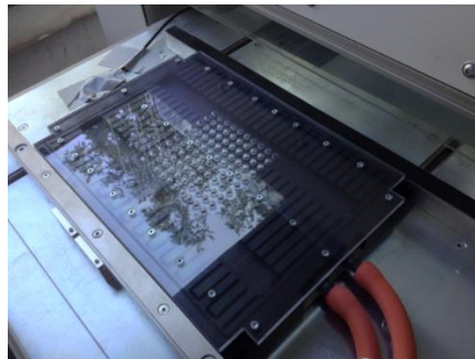
Abbildung 12: (A) Siebdruckmaschine EKRA1, (B) Vakuuttisch zur Befestigung und Positionierung der keramischen Elektrolyten und (C) 3YSZ-Elektrolyte der Fa. CeramTec.
