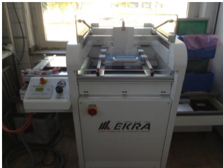
Abbildung 12: (A) Siebdruckmaschine EKRA1, (B) Vakuuttisch zur Befestigung und Positionierung der keramischen Elektrolyten und (C) 3YSZ-Elektrolyte der Fa. CeramTec.
