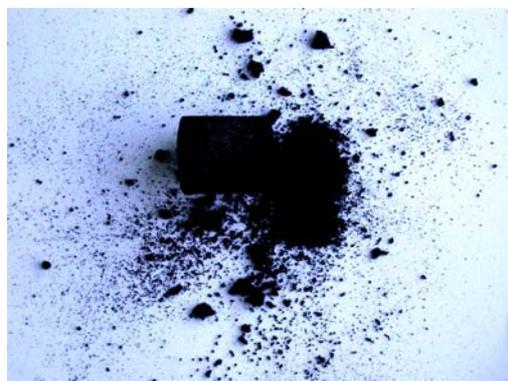
**Abb. 73.** Kohlenstoffabscheidung an einer Pd-beschichteten Probe. Versuchsbedingungen: 600°C, 1bar, Propan:Wasserdampf = 1:1, Propan-Feed 30ml<sub>N</sub>.min<sup>-1</sup>, Versuchsdauer: 25h.
