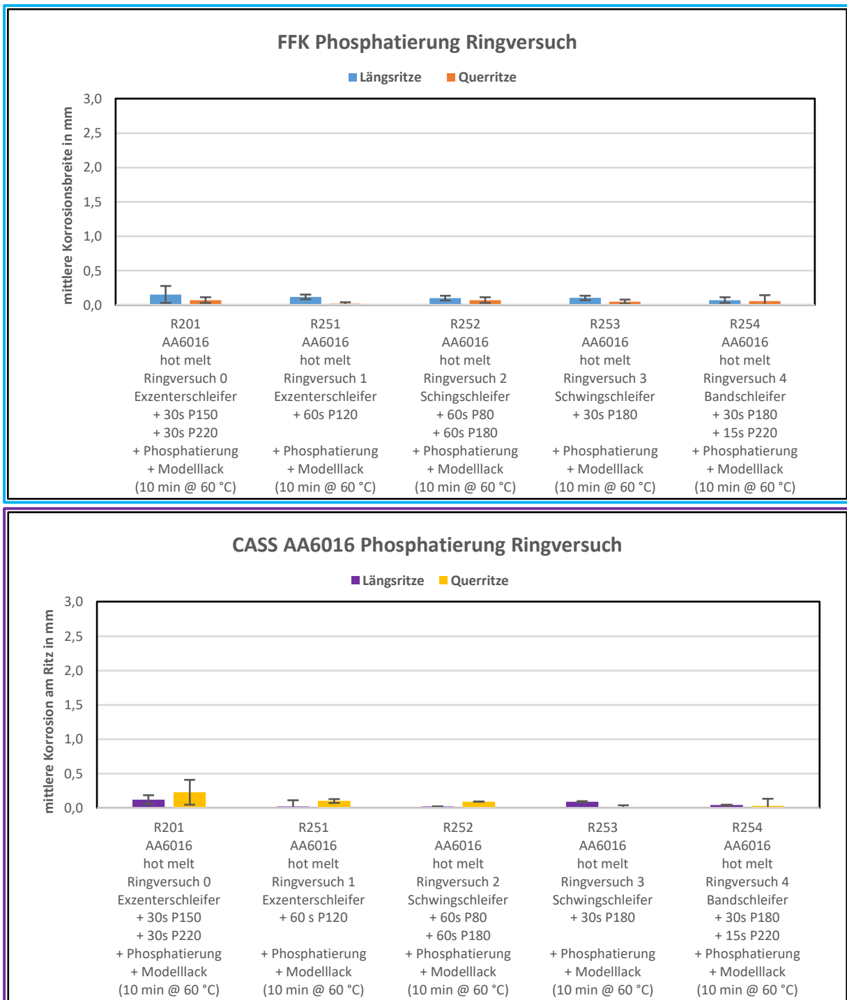
Abb. 88: Ergebnisse des vergleichenden Filiformkorrosionstests (oben) und CASS-Tests (unten) der im Rahmen des Ringversuch „Automobile“ hergestellten Proben der Legierung AA6016 mit Phosphatierung.
