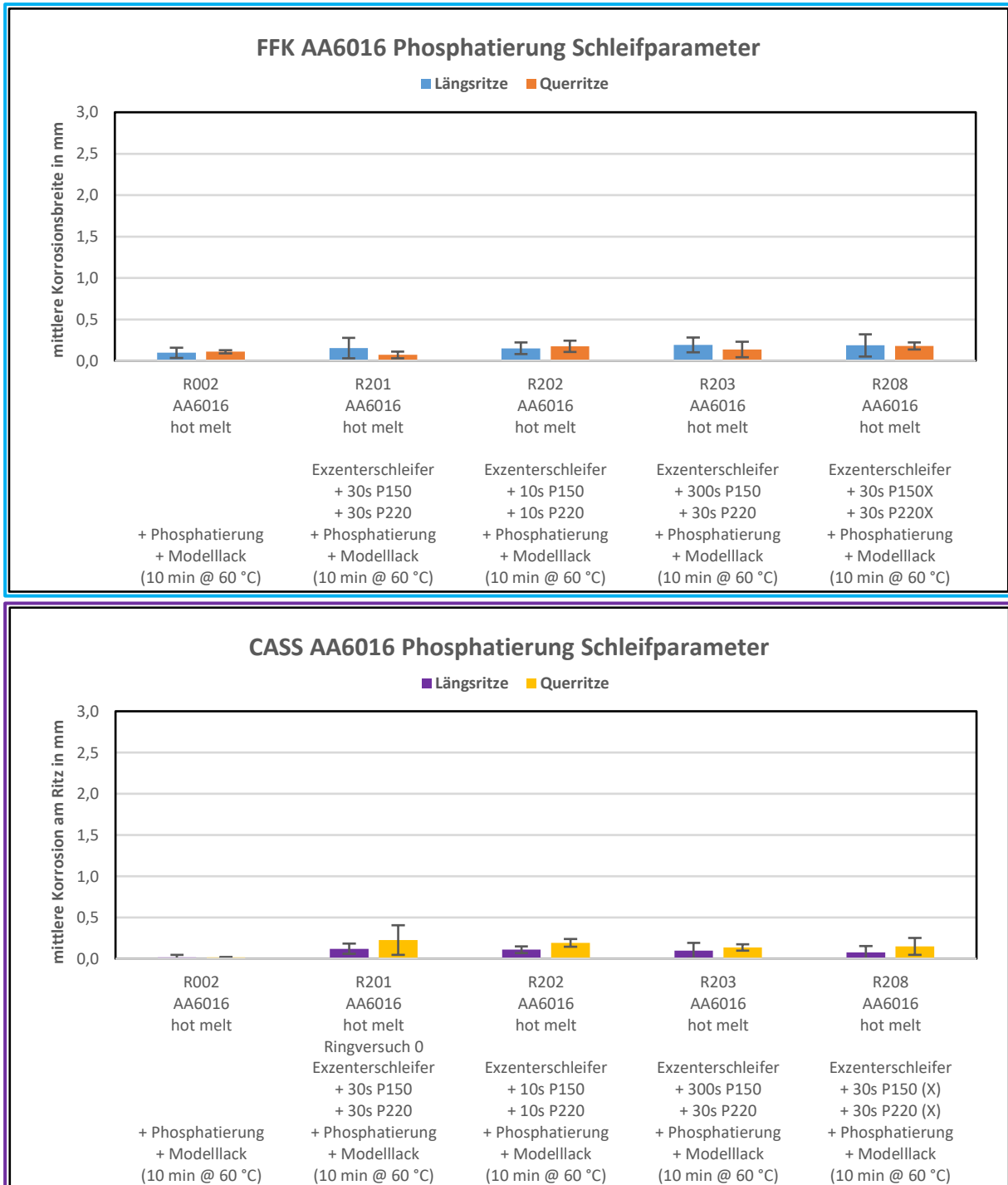
Abb. 91: Ergebnisse vergleichender Filiformkorrosionstests (oben) und CASS-Tests (unten) an Blechen der Legierung AA6016 unter Variation des Schleifprozesses und anschließender Phosphatierung.
