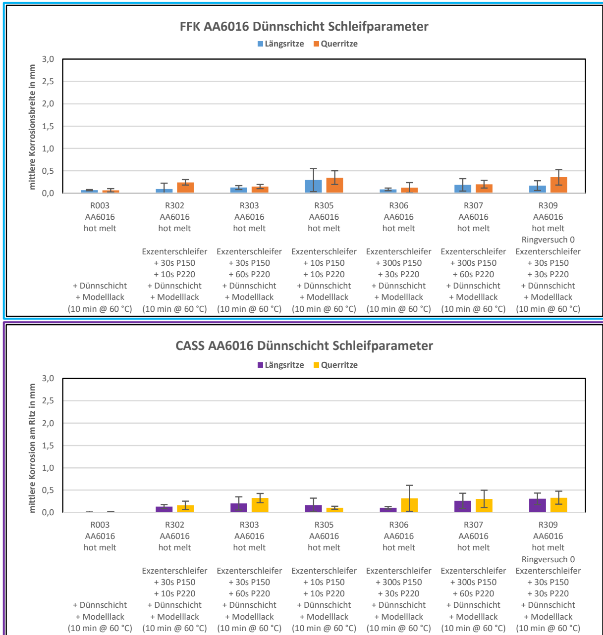
Abb. 92: Ergebnisse vergleichender Filiformkorrosionstests (oben) und CASS-Tests (unten) an Blechen der Legierung AA6016 unter Variation des Schleifprozesses und anschließender Dünnschichtvorbehandlung.
