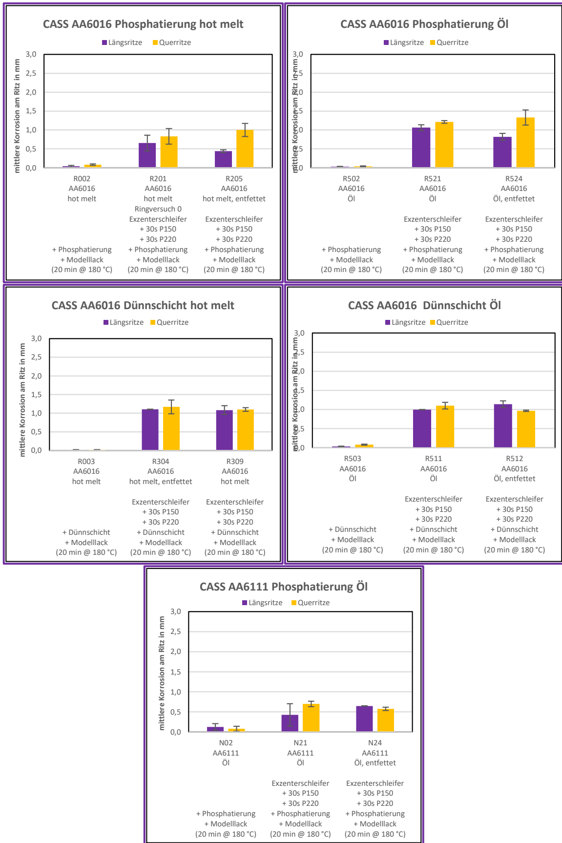
Abb. 104: Ergebnisse vergleichender CASS-Tests an beschichteten Blechen nach dem Einbrennen bei 180 °C unter Variation der Legierung, Vorbehandlung und Art der Beölung.
