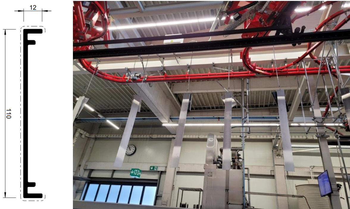
Abb. 52: Links: Querschnittsprofil der für den Ringversuch „Fassade“ verwendeten Proben (Längenangaben in mm). Rechts: Aufhängung der Profile auf der Traverse vor der Oberflächenvorbehandlung.
