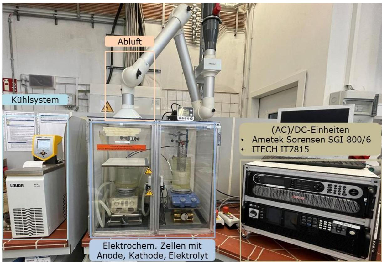
Abbildung 3: Aufbau des Versuchsstands zum Plasmaanodisieren mit der neu angeschafften AC/DC Pulstromversorgungseinheit.
