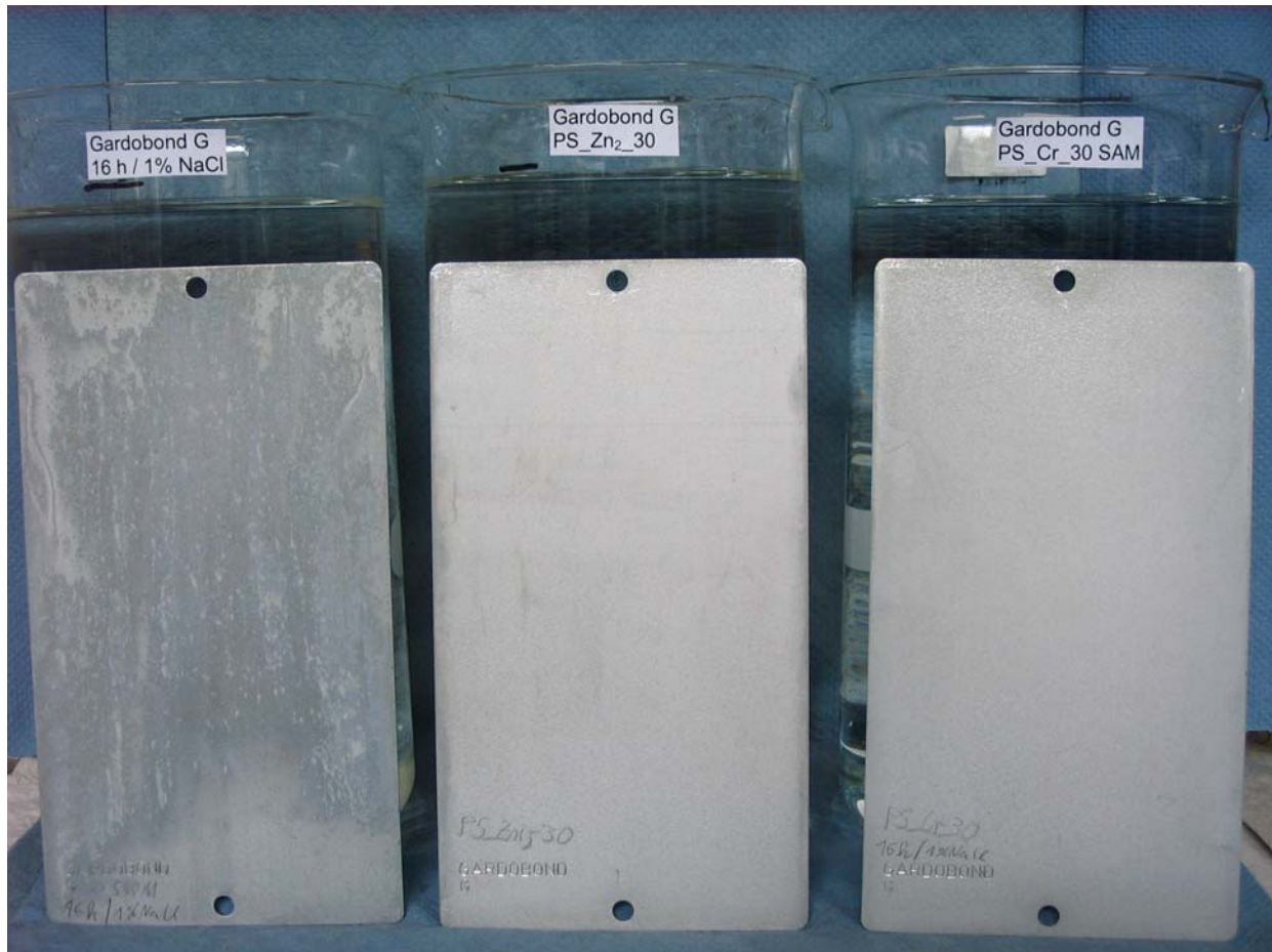
Abb 4 : Galvanisch verzinkte Bleche (Gardobond G / entfettet) ohne SAM (links) und mit SAM-Beschichtungen auf Basis von Phytinsäure (mitte und rechts) nach 16 h Dauertauchversuch in belüfteter 1 % iger NaCl.
