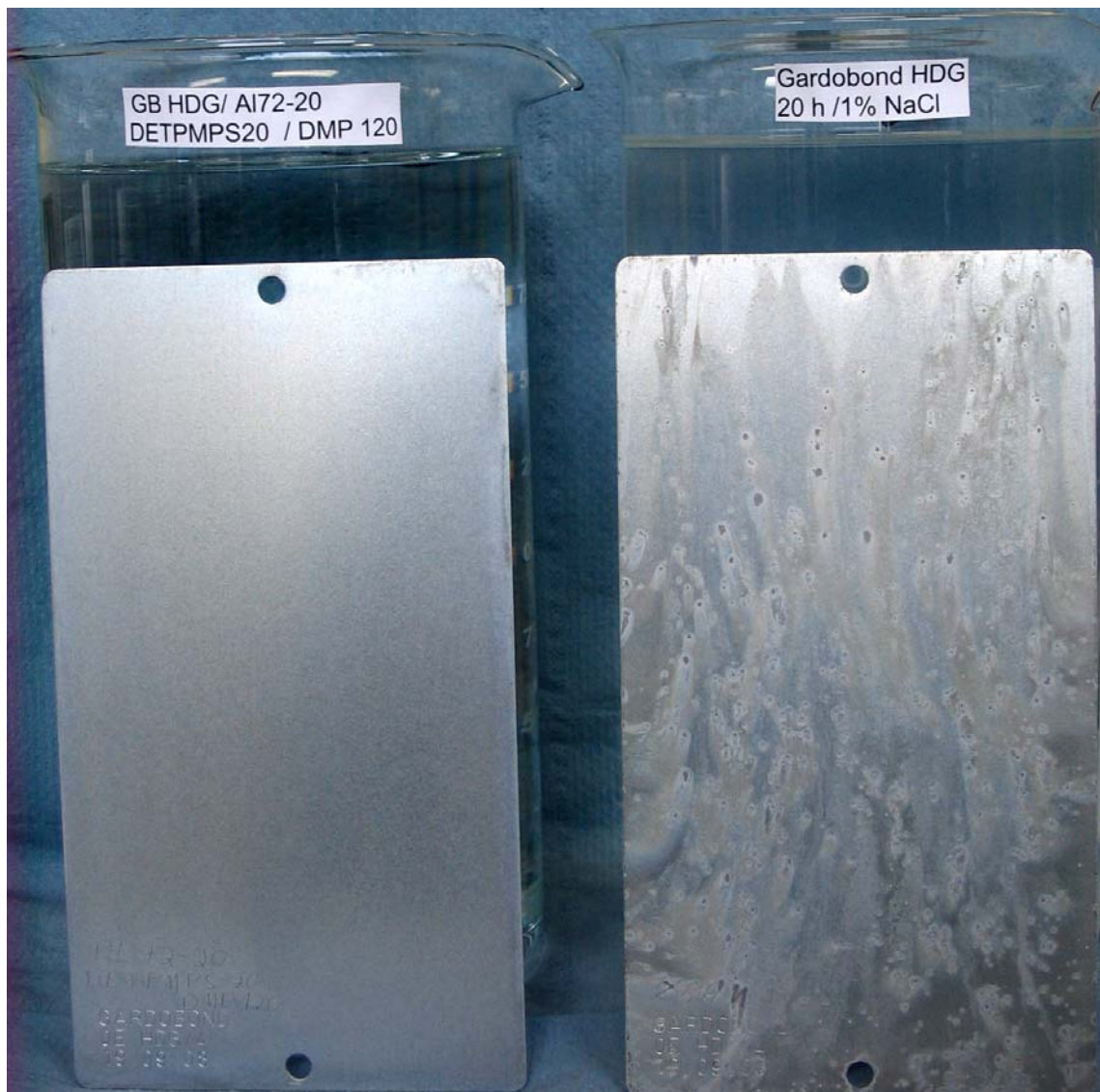
Abb 8 : Feuerverzinkte Testbleche (Gardobond HDG / entfettet) ohne Vorbehandlung [rechts] und nach saurem Dekapieren (Alfideox 72) mit DET_20 TG und nachfolgendem DMP 120 – Tauchgang [links]. Beide Bleche waren 20 h in einer belüfteten 1% igen NaCl getaucht worden.
