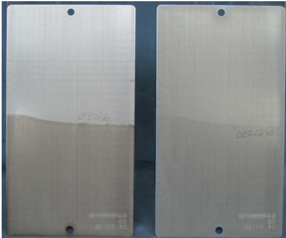
Abb 9: Elektrolytisch verzinkte Stahlbleche (Gardobond OG / elektrolytisch verzinkt/ entfettet) nach 15 Sek. Tauchen des jeweils unteren Abschnittes in 0.004 M \text{CuSO}_4 , was zur Verfärbung nach Dunkelgrau (beginnende Verkupferung) führte. Linkes Blech : ohne weitere Vorbehandlung / Beschichtung Rechtes Blech : DET_Cr 30 – Tauchgang (vgl. Tabelle 23 oben).
