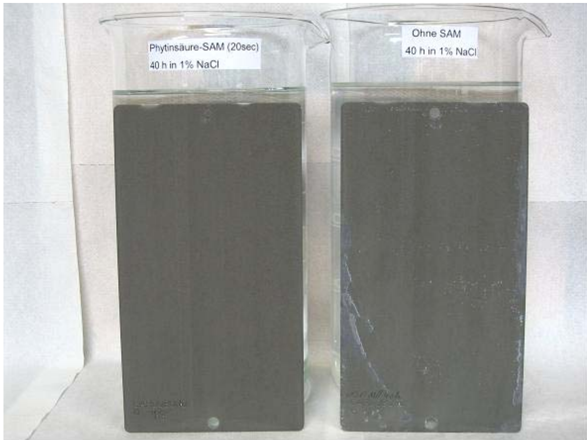
Abb 7 : Galvanisch verzinkte Bleche mit Zinkphosphatierung (Gardobond G / 28 S) ohne SAM (rechts) und mit SAM – Beschichtungen auf Basis von Phytinsäure (links) nach 40 h Dauertauchversuch in belüfteter 1 % NaCl.
