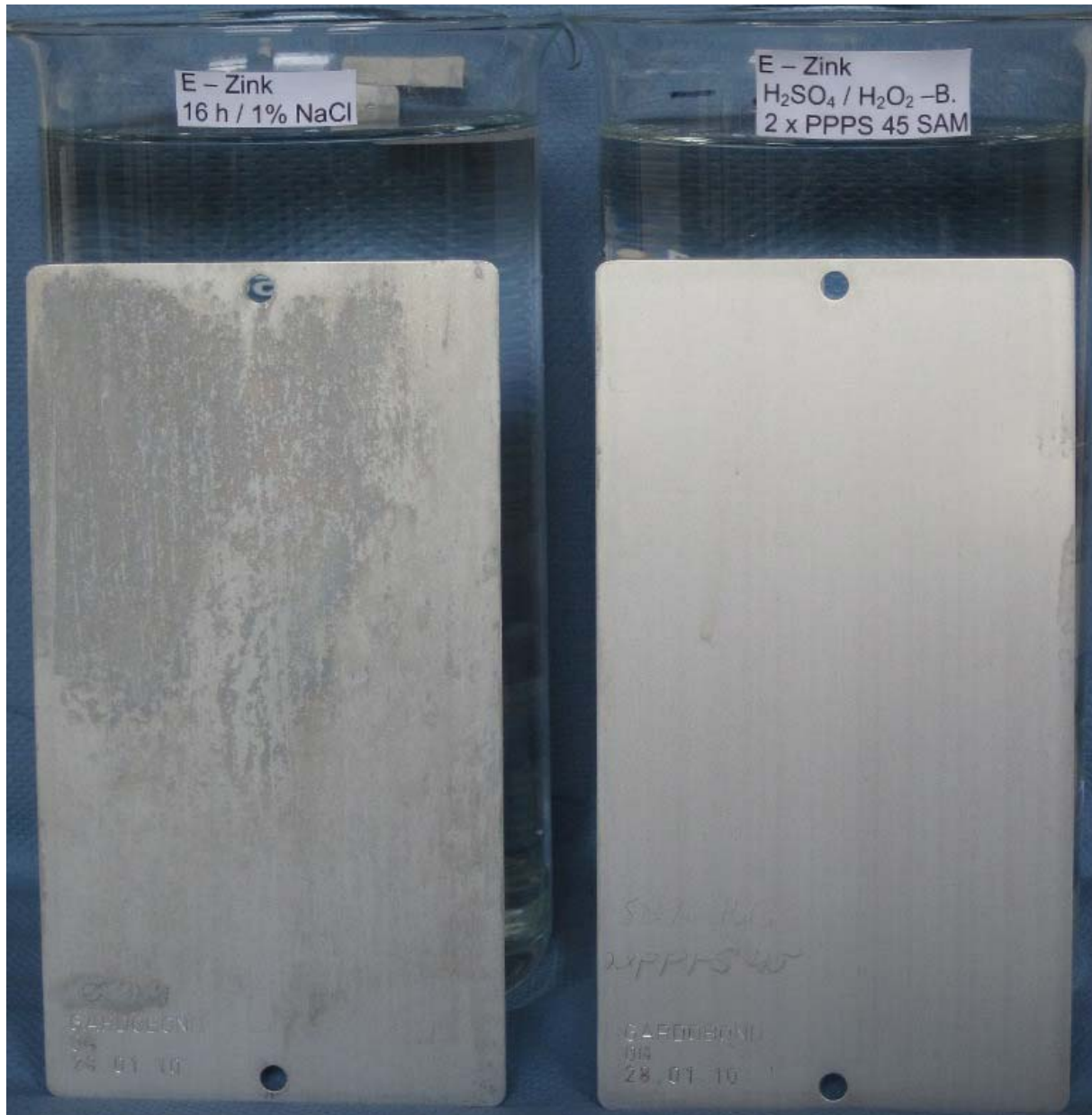
Abb 5: Galvanisch verzinkte Bleche (Gardobond OE / elektrolytisch verzinkt / entfettet) ohne SAM (links) und mit PPPS – SAM (nach saurer Vorbeize mit Schwefelsäure/ H 2 O 2 ) nach 16 h Dauertauchversuch in belüfteter 1% -iger NaCl.
