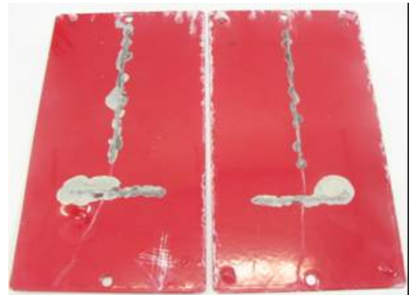
13-14 Mild-alkalisch entfettet + saures Dekapieren (SB10_H 2 O 2 – Beize) + PS_Cr20 – Tauchgang + DTOA_30 - TG
