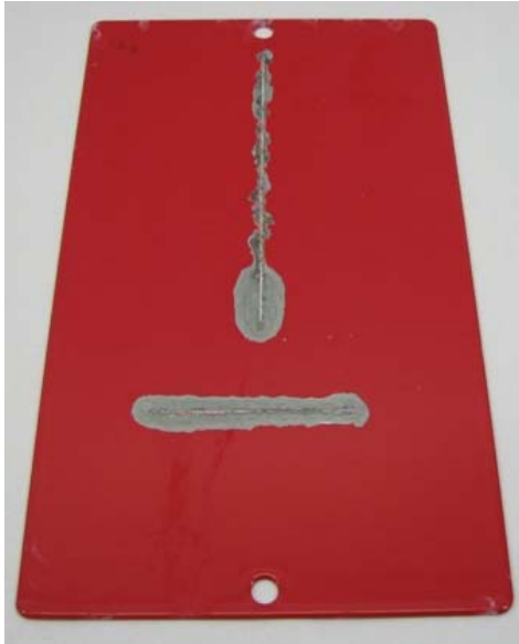
Blech S-2 : Hochalkalische Beize + saures Dekapieren (SB10_H 2 O 2 )
