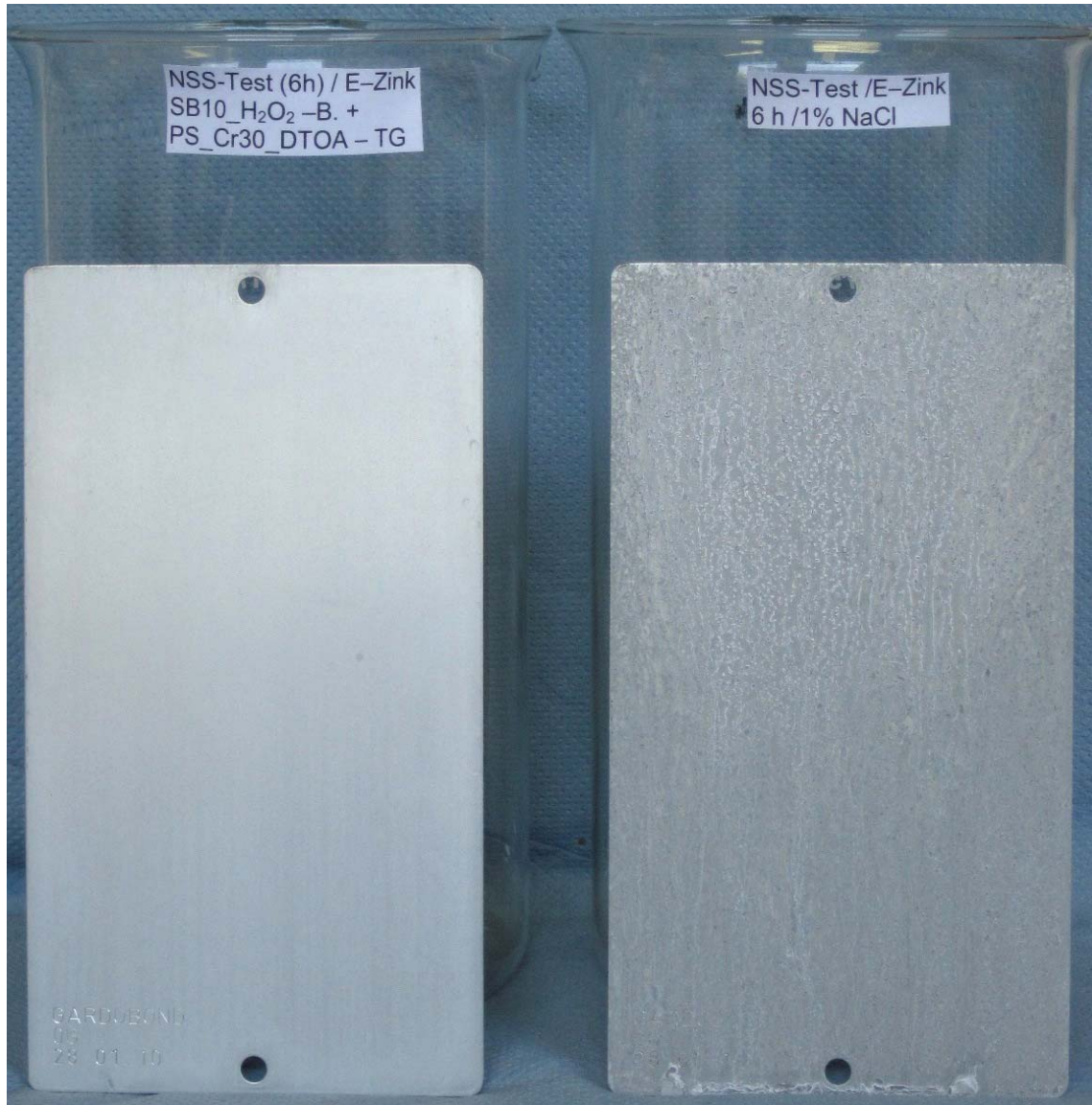
Abb 12: Elektrolytisch verzinkte Testbleche (Gardobond OG / Elektrolytisch verzinkt / entfettet) nach 6 h in der Salzsprühnebelkammer (35° C/1% NaCl).
