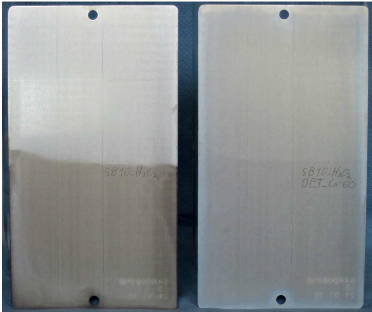
Abb 10 : Elektrolytisch verzinkte Stahlbleche (entfettet und mit Schwefelsäure / H_2O_2 sauer dekapiert) nach 15 Sek. Tauchen der unteren Blechhälfte in 0.004 M CuSO_4 . Linkes Blech : ohne Vorbeschichtung ; Rechtes Blech : vorbeschichtet mit DET_Cr 60 – Tauchgang (vgl. Tabelle oben). Hier ist eine schwache bläuliche Verfärbung der Oberfläche durch den DET_Cr 60 – Tauchgang erkennbar.
