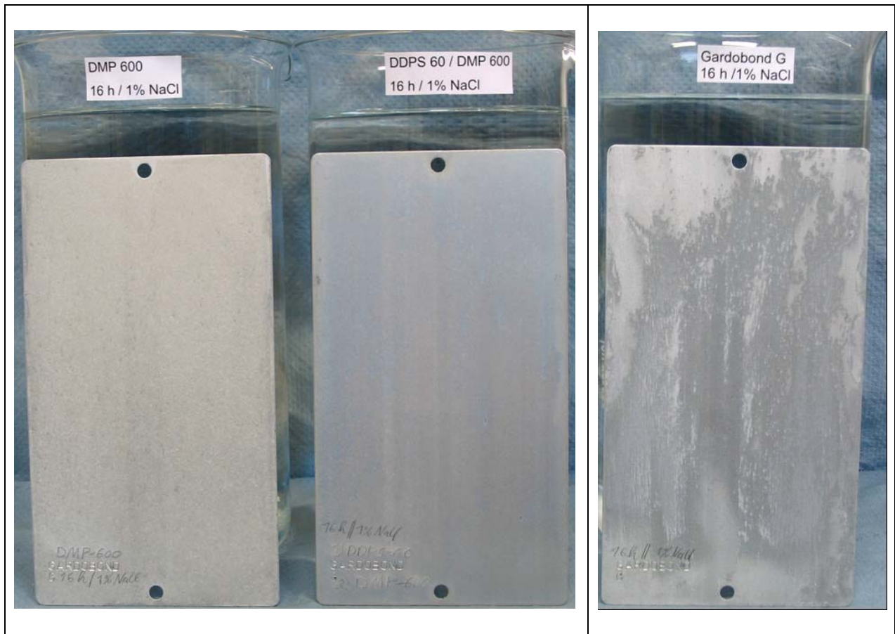
Abb 6 : Galvanisch verzinkte Bleche (Gardobond G / entfettet). Rechts : ohne weitere Behandlung. Links : Vorbeschichtung durch 10 Min. Tauchen in 10^{-3} M DMP (10% Ethanol; 45^{\circ} C); Links : Vorbeschichtung mit DDPS – Tauchgang und anschließendem analogen DMP – Tauchgang. Alle Bleche waren nach der Vorbeschichtung 16 h in belüftete 1 % ige NaCl getaucht worden.
