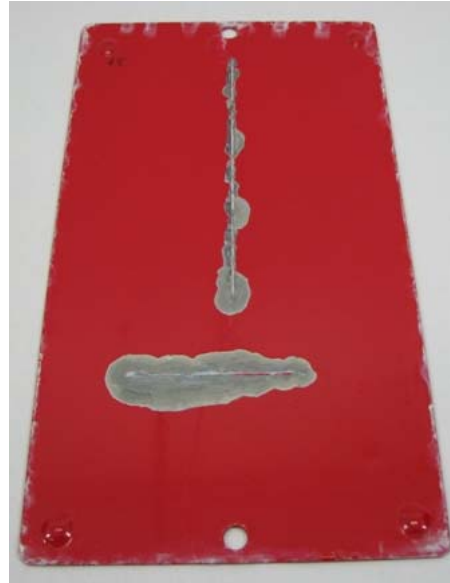
Blech 15 : mild-alkalisch entfettet + saures Dekapieren (SB10_H 2 O 2 – Beize) + PS_Cr20-TG + DTOA 30 - TG
