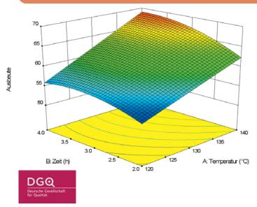
Moderne Fertigungsprozesse bieten immer mehr Einstellmöglichkeiten, immer mehr Anlagenparameter können verändert werden. Doch welche Parameter sind überhaupt wichtig? Welche Einstellungen liefern die besten Ergebnisse? Dazu werden Versuche durchgeführt.
