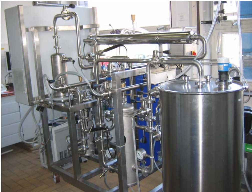
Abb.18: Versuchsanlage zur elektrochemischen Ozonproduktion
