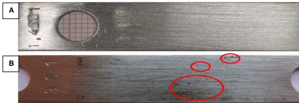
Abbildung 29: Darstellung der nach Standardverfahren mit carboxyethyl- \beta -Cyclodextrin (CEBCD) beschichteten Coupons vor (A) und nach (B) Auslagerung und Reinigung der Proben aus hochlegiertem Stahl.
