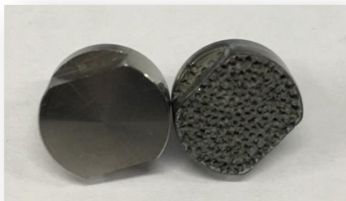
Abb. 2.2.3: Kavitationsschaden an Sonotrode (rechts) neue Sonotrode (links).
