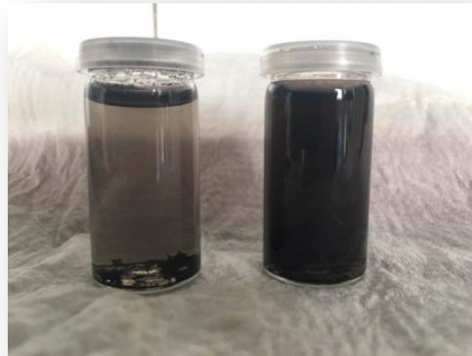
Abb. 4.1.2: In Wasser dispergierte SWCNT (links Ausgangsmaterial, rechts funktionalisierte SWCNT).
