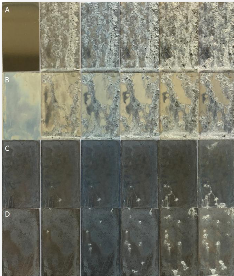
Abb. 4.4.5.3.1: Proben (A-D) im Salzsprühtest (Spalte: Start, 24 h, 48 h, 72 h, 144 h und 168 h); Geschliffenes AZ31 (A), AZ31 mit Ceroxid-Halloysit-Schwamm (B), AZ31 mit Ceroxid-Halloysit-Schwamm und 3 Tage Wasserdampfbehandlung (C), AZ31 mit Ceroxid-Halloysit-Schwamm, 6 Tage Wasserdampfbehandlung und Silan-Beschichtung (D).
