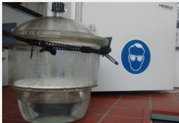
Abb. 3.6.1: Exsikkator und Trockenschrank für die heiß Wasserdampf Behandlung.
