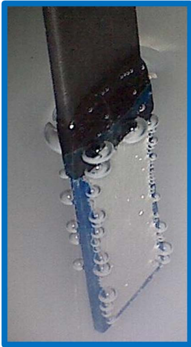
Abb. 2.2.1.b: Aufnahme der Proben nach 79 s Anodisdauer (blau Versuch bei 20°C, rot Versuch bei 40°C).
