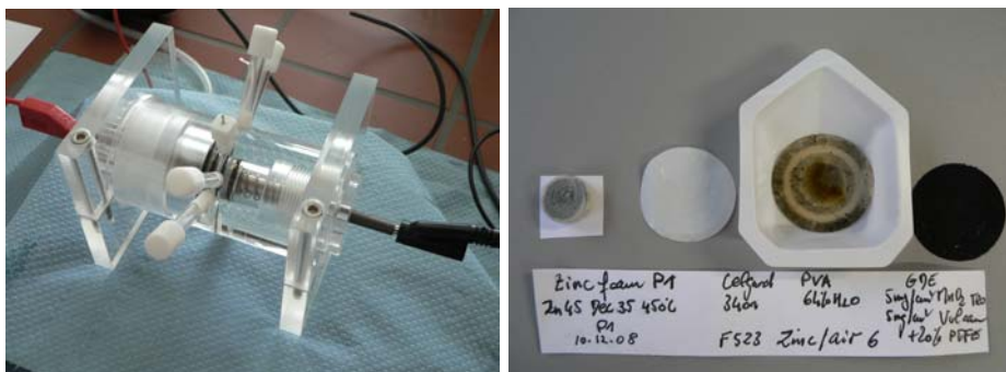
Abbildung 74: Zink/Luft-Laborzelle (Anode 13mm : Kathode 27mm) mit Komponenten nach dem Entladevorgang.
