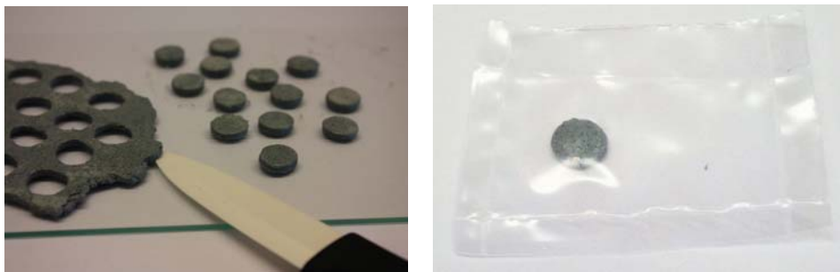
Abbildung 52: Zn-Pasten-Elektroden (Bilder: Fa. Brüggemann).
