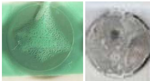
Abbildung 103: Zellen mit (links) H 2 -Blasen und (rechts) einer Kaliumkarbonat-Schicht
