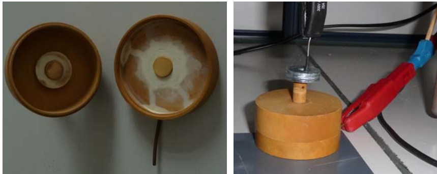
Abbildung 24: Test-Zelle mit blockierenden Goldelektroden für die Impedanzmessungen zur Ermittlung der spezifischen ionischen Leitfähigkeit von Elektrolytmembranen; links: geöffnete Zelle mit den beiden Goldelektroden; rechts: geschlossene Zelle mit den elektrischen Anschlüssen.
