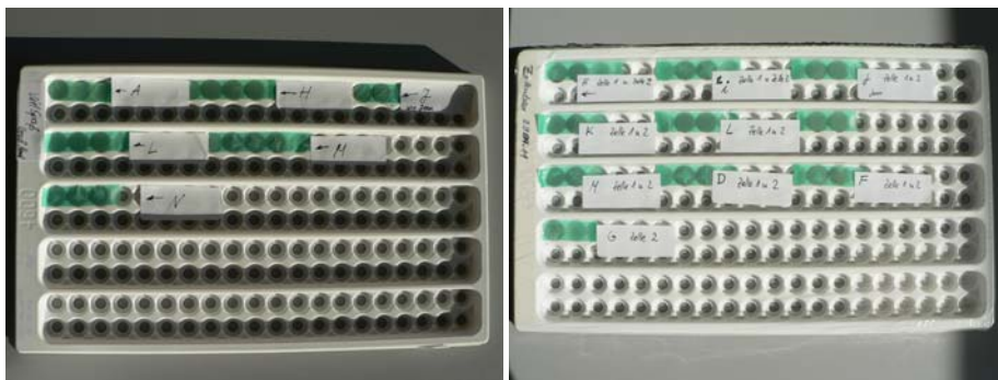
Abbildung 102: Zn/Luft-Zellen die (links) in Feb. und (rechts) in April bei der DECHEMA getestet wurden; Die richtige Reihenfolge der April-Probe lautet von oben links: H, I, J, K, L, M, D, E, F, G.
