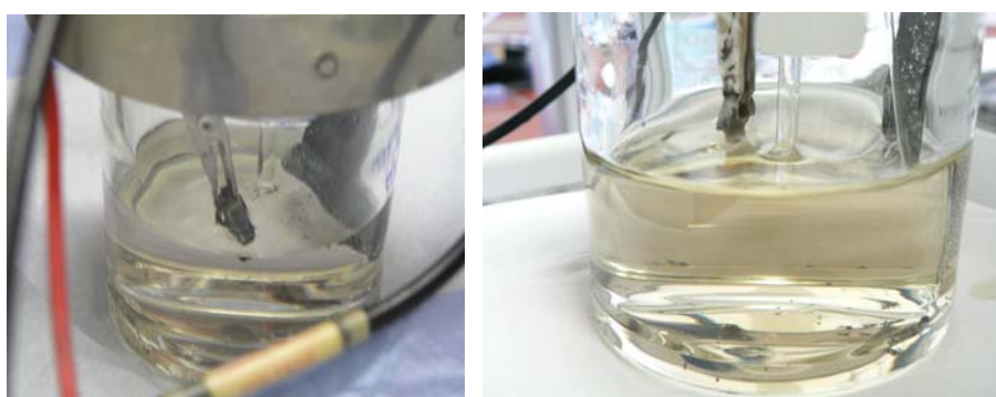
Abbildung 68: Versuchsanordnung mit der Zink-Arbeitslektrode, dem Luggingkappillar und C-Papier als Gegenelektrode am (links) Versuchsbeginn und (rechts) Versuchsende.
