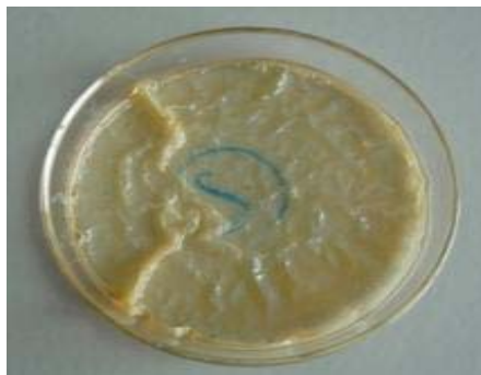
Abbildung 22: Ausgegossene PAA/PVA-Membran nach Aktivierung mit 6 molarer KOH.
