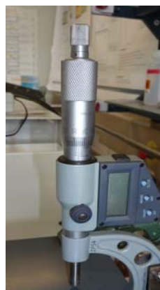
Abbildung 27: Digitales Dickenmessgerät zur Bestimmung der Dicke der Membranen.
