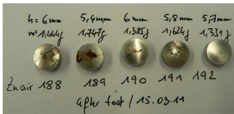
Abbildung 107: Einige Zn/Luft-Zellen von Feb. 2011 nach dem Lade-/Entladetest.
