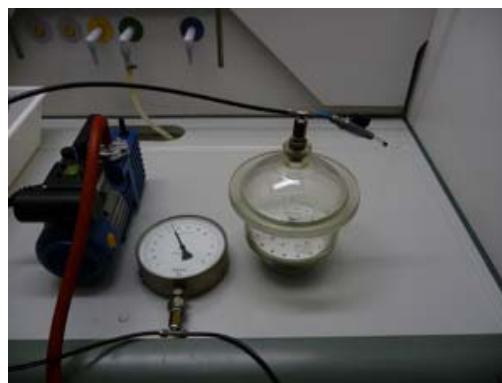
Abbildung 41: Apparatur zur Imprägnierung von porösen Zink – Anoden mit PVA - Lösung niedriger Viskosität ( PVA 30000 [Merck])
