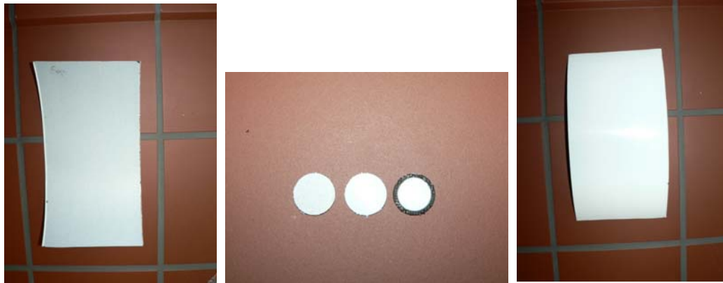
Abbildung 63: GDE mit (links) Separator und (rechts) PTFE-Folie der Fa. Varta. (Mitte) Ausgestanzte Elektroden.
