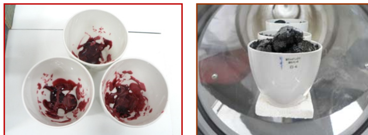
Abbildung 12: Perowskit (links) vor und (rechts) nach der Kalzinierung.
