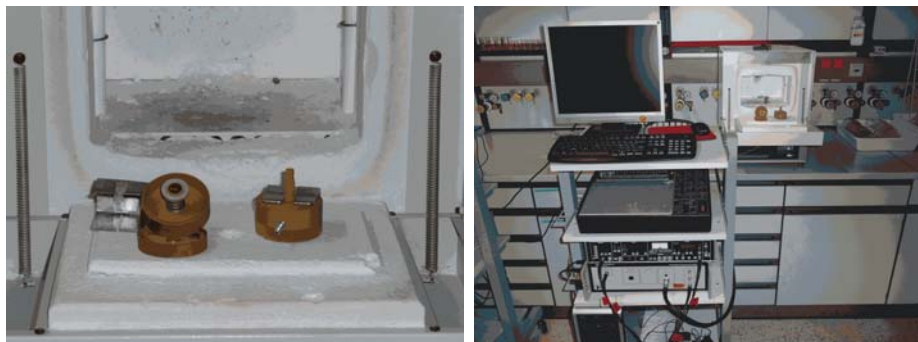
Abbildung 25: Messzelle und Vergleichszelle im Ofen (links) und Apparatur für die Ermittlung der Leitfähigkeit mit Hilfe der EIS (rechts).
