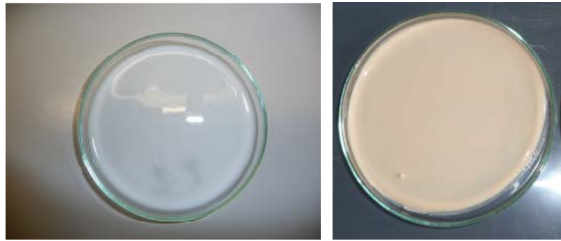
Abbildung 18: (Links): In einer Petrischale ausgegossene mit \text{TiO}_2 modifizierte PVA/KOH/ \text{H}_2\text{O} – Membran mit PVA/KOH/ \text{TiO}_2 = 3:4:0,5 ; Wassergehalt ca.70%, PVA 145000 (Merck). (Rechts): ausgetrocknete PVA/KOH Membran mit 1 g \text{TiO}_2 (2,9 Gew. %); PVA/KOH = 3:4; Wassergehalt 70 – 72 Gew. %.
