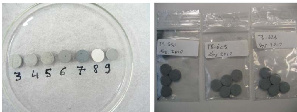
Abbildung 48: Zn-Schäume (links) vom Typ 8 (Juni-Aug. 2010) und (rechts) von Typ 9 (Nov. 2010).
