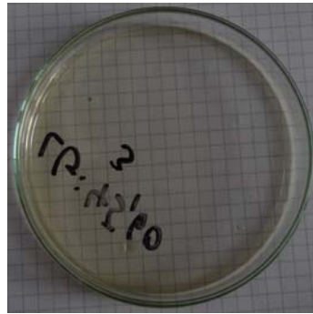
Abbildung 16: PVA/KOH-Membran in Petrischale; PVA/KOH Verhältnis 3:4; Wassergehalt 60-65%.
