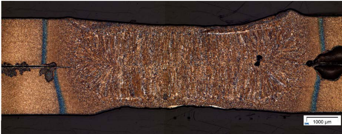
Abbildung 48: Überblick des Schweißpunkts (Widerstandsschweißung) des Probenpaares 281+282, linke Seite, Klemmätzung.
