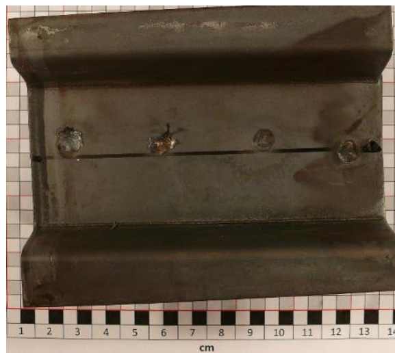
Abbildung 47: Makroskopische Aufnahme des mittels Widerstandspunktschweißen gefügten Doppelhutprofilpaares 281+282.
