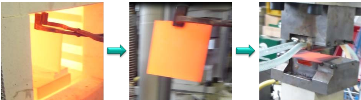
Abbildung 43: Ablauf der Presshärteversuche am IEHK.
