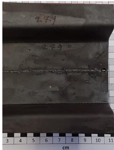
Abbildung 51: Makroskopische Aufnahme des mittels Laserstrahlschweißens gefügten Doppelhutprofilpaares 279+280.
